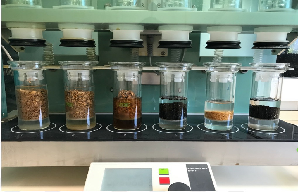
Şekil 3.4. Soxhlet cihazında atık mantar kompostu ekstraksiyonu
