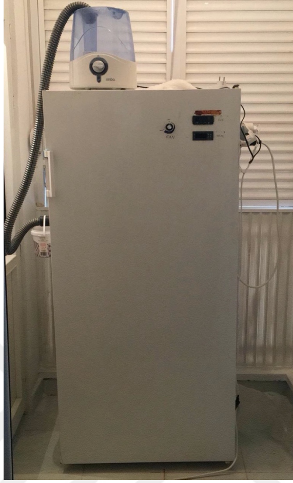
Şekil 3.3. Mantar üretimi için modifiye edilmiş buzdolabı
