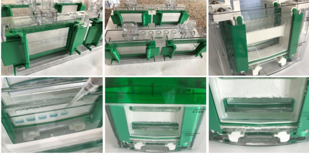
Şekil 9.9. Elektroforez tankının hazırlanması, örneklerin kuyucuklara eklenmesi ve elektrik akımının verilmesi
