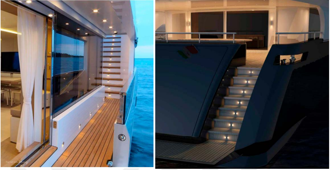
Şekil 116: Motoryat, Merdiven Aydınlatmaları
