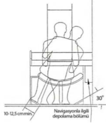
Şekil 92: Yalpa Hareketinin Oturma Yüzeyi Tasarımına Etkisi ve Ayak Mesafesi
