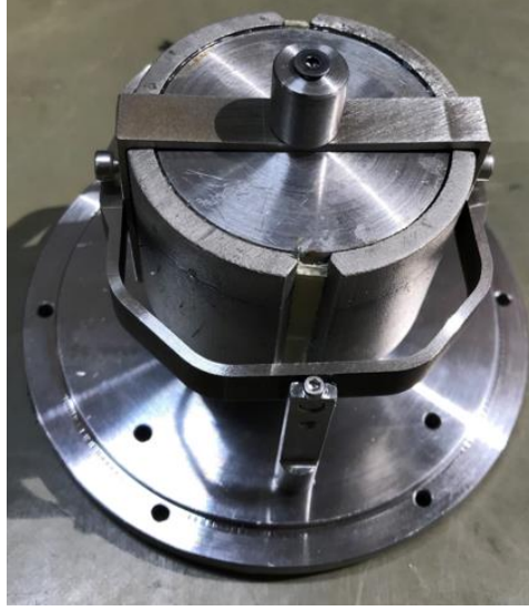
Şekil 5.5 Rotorun hareketini sağlayan eksenler ve eksen milleri
