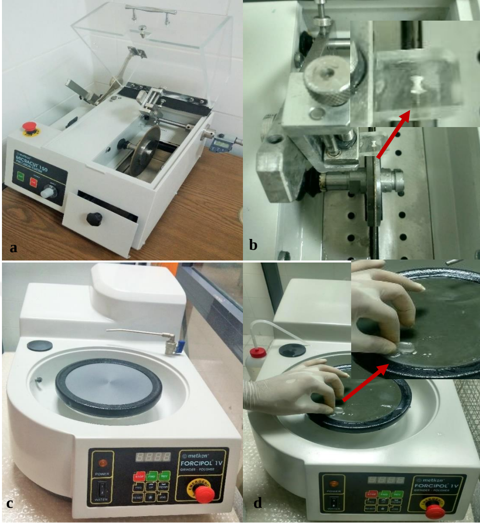
Şekil 3.5. Metkon Microcut 150 ile hassas kesim işlemi (a-b) , Metkon Forcipol V1 makinesi ile aşındırma/parlatma işlemi (c-d)
