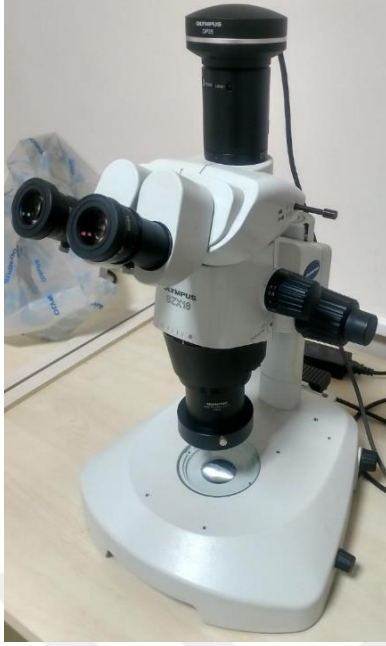
Şekil 3.6. Video kameralı stereo mikroskop Olympus SZX16
