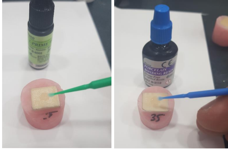
Resim 14 Zirkonya örnek yüzeyine Z-prime ve Porselen Bonding Rezin uygulaması
