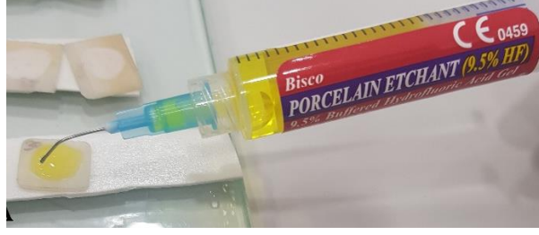
Resim 16 Feldspatik porselen örneklere HF asit uygulanması
