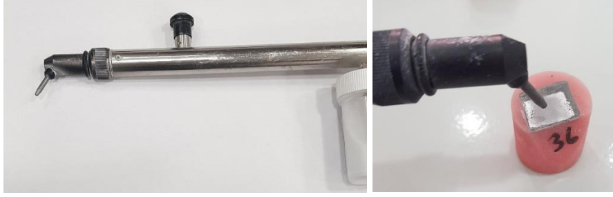
Resim 10 Çalışmada kullanılan tribokimyasal silika kaplama cihazı ve metal örneklere tribokimyasal silika uygulaması
