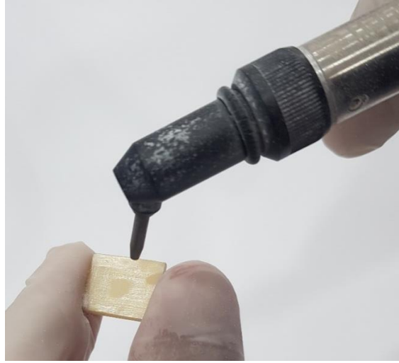
Resim 13 Zirkonyum oksit seramik yüzeyine tribokimyasal silika kaplama uygulaması
