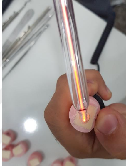
Resim 15 Feldspatik porselen örnek yüzeyine soğuk plazma uygulaması
