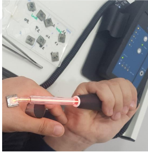
Resim 9 Metal alařımı rneklere soėuk plazma uygulanması
