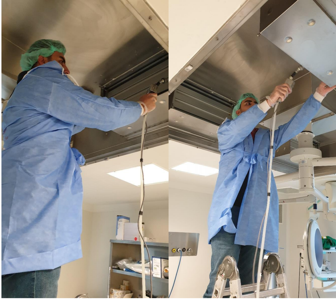
Resim 6.4. HEPA filtre DOP testi
