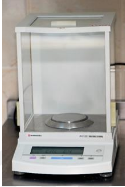
Şekil 3.16. Hassas terazi Shimadzu AX120 ( Shimadzu corporation, Kyota, Japonya)
