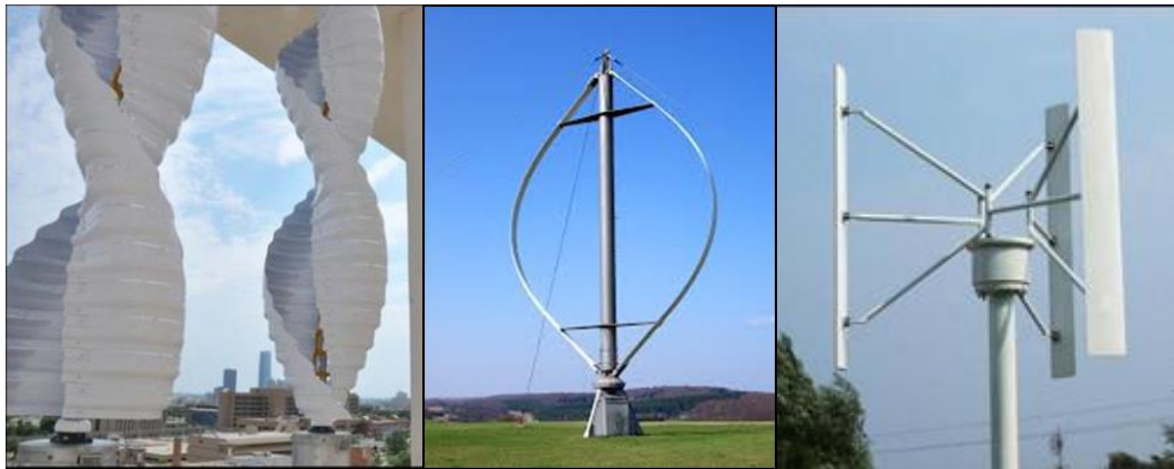
Şekil 1.7. Dikey eksenli rüzgâr türbinleri(Savonius ve Darrieus) [14]
