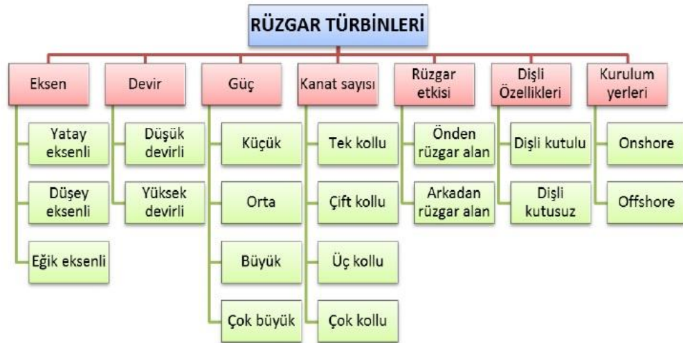
Şekil 1.4. Rüzgâr Türbini Sınıflandırma Tablosu[14]
