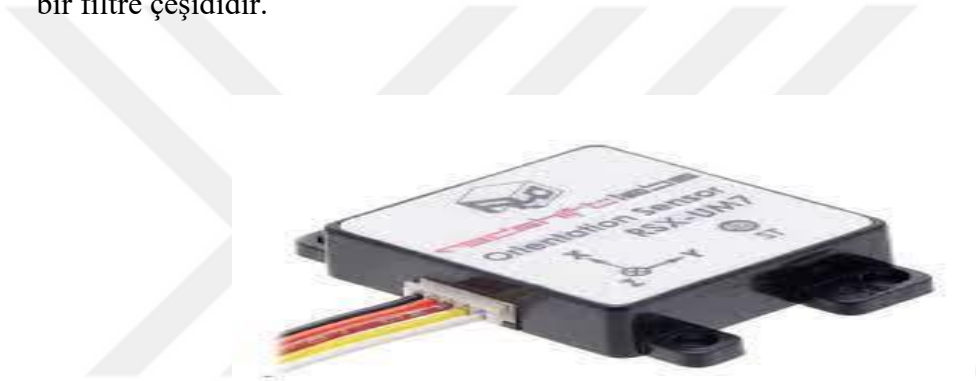
Şekil 2.9 UM7 yönelim sensörü
