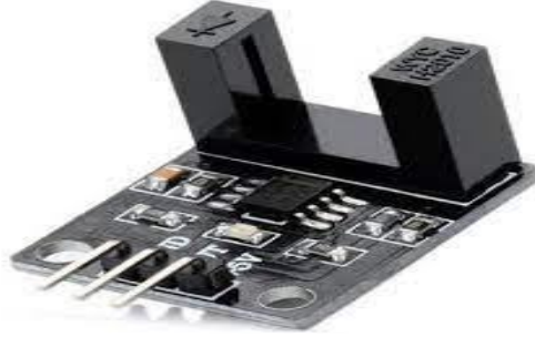
Şekil 2.7 Motor hız sensörü (HC-89)
