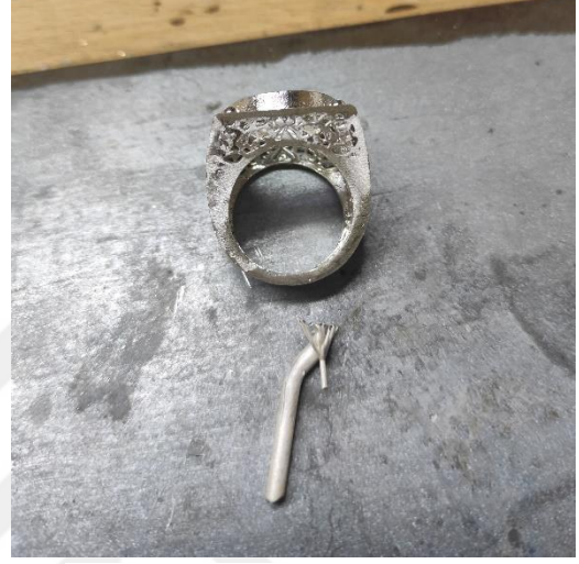
Görsel 5.16: B modelinin üç boyutlu yazıcıdan çıkması (Tezci,2021, Çekim Tarihi: 17.05.2021)
