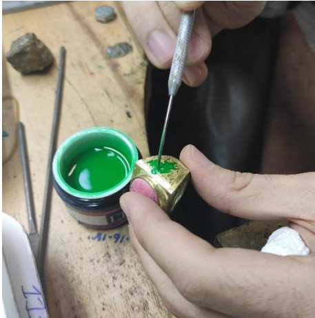
Görsel 5.13: A modeline mine(emay) tekniğinin uygulanması (Tezci,2021, Çekim Tarihi: 19.05.2021)
