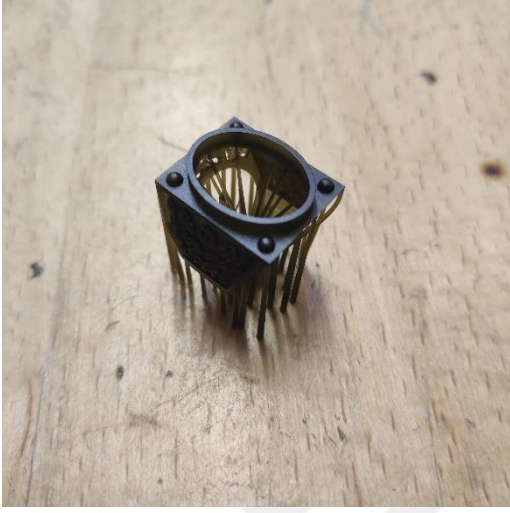
Görsel 5.16: B modelinin üç boyutlu yazıcıdan çıkması (Tezci,2021, Çekim Tarihi: 17.05.2021)
