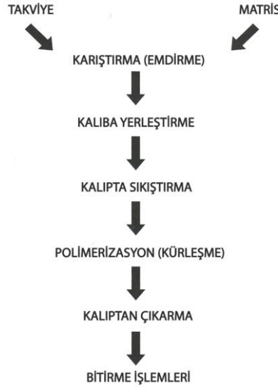
Şekil 1.11. Polimer matrisli kompozitlerin üretim aşamaları [22].
