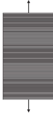
Şekil 1.8. Lif eksenine dik yönde yük uygulanan kompozit malzeme. [38].
