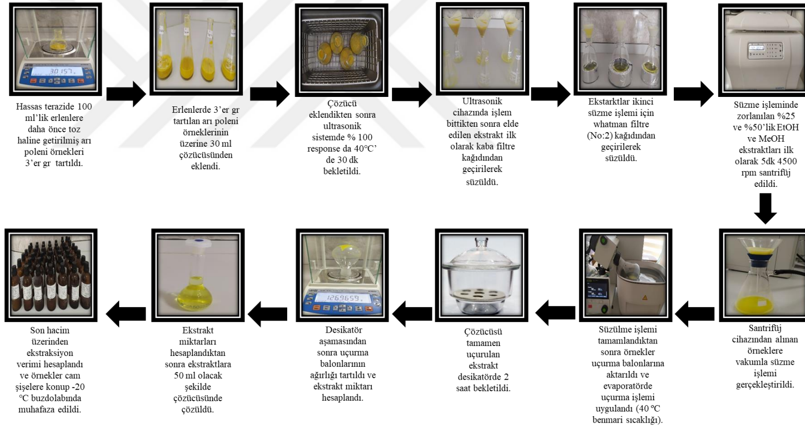
Şekil 3.4. Ekstraksiyon işleminin aşamalarını gösteren diyagram
