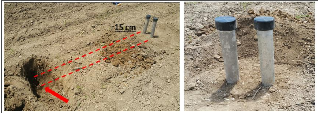
Şekil 3.7. Deneme parsellerinde nötron tüplerinin konumu
