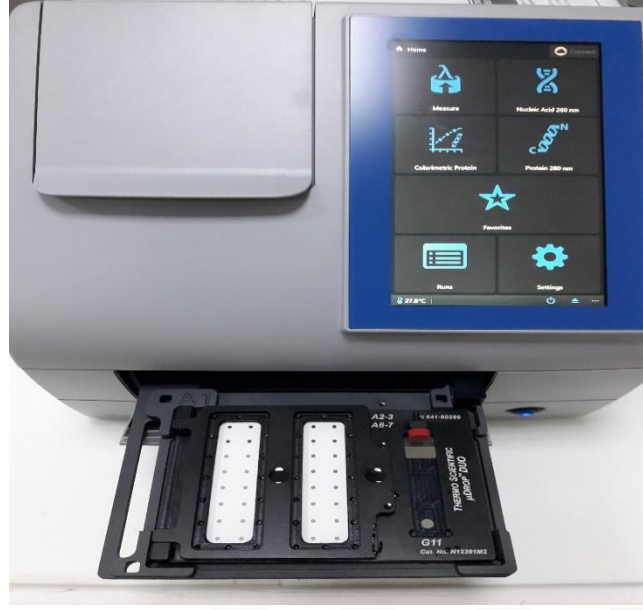
Şekil 2.2: Thermo Scientific™ µDrop™ Duo (Thermo Fisher, U.S.A.) Plakasında protein konsantrasyon ölçümü
