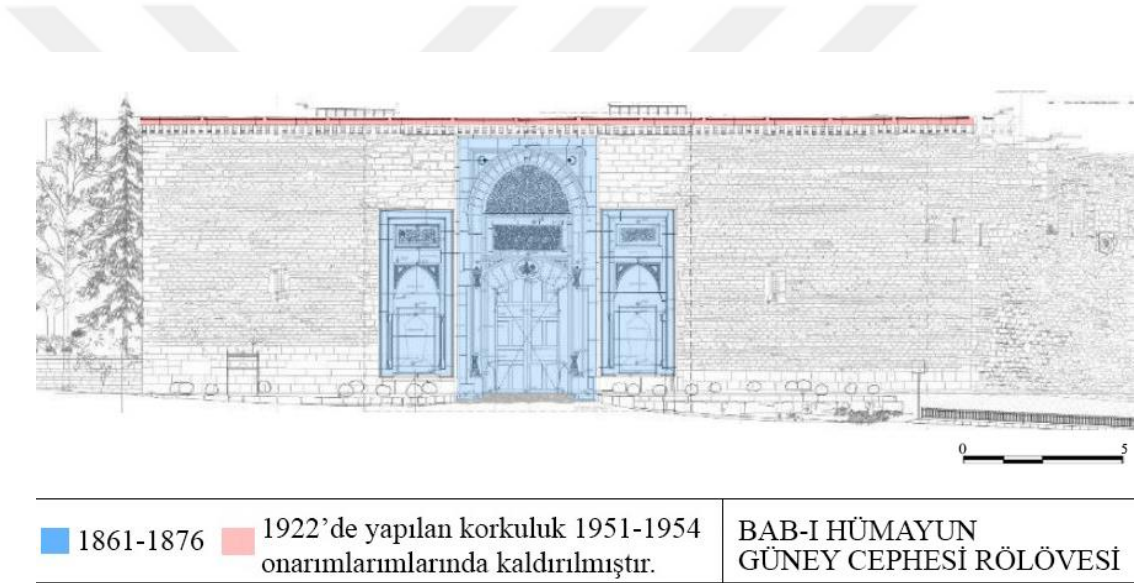
Görsel 1.5: Bab-ı Hümayun Güney Cephesi'ndeki onarımların tarihlendirilmesi 25
