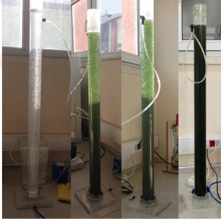
Şekil 3.1. Bu çalışmada kullanılan kabarcıklı kolon fotobiyoreaktör (Gazioğlu, 2020).
