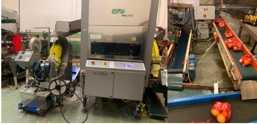
Şekil 3.3. W.Murcott mandarin çeşidinde sorma fileleme makinası ile uygulama
