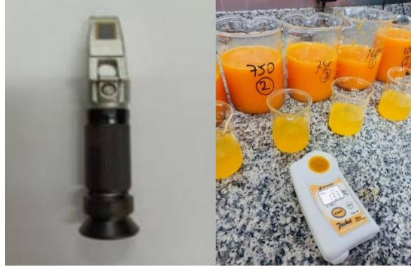
Şekil.3.10. El ve standart refraktometre ile % SÇKM ölçümleri
