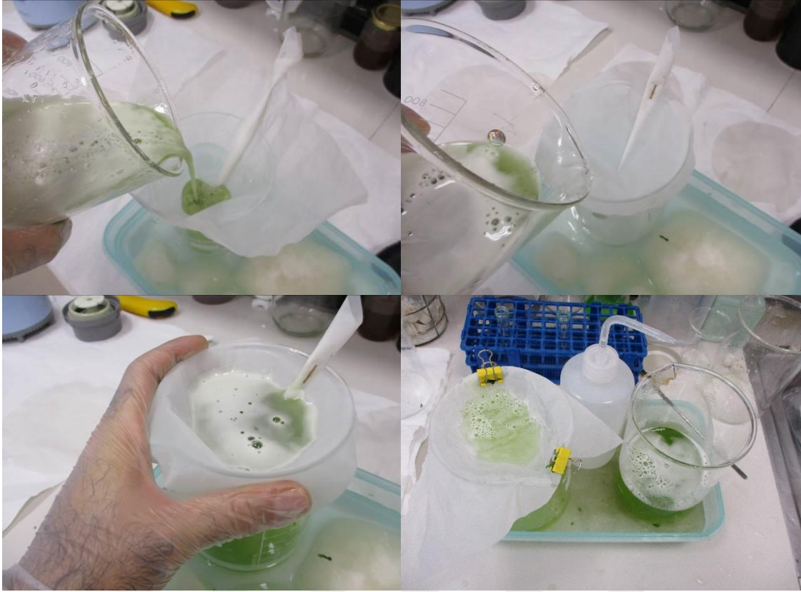
Şekil 3.6. Salgı tüyü izolasyon tamponunun sırası ile 105 \mu\text{m} ve 40 \mu\text{m} boyutlarında gözenek açıklığına sahip filtrelerden geçirilmesi ve elek üstünün pastör pipeti ile toplanması.
