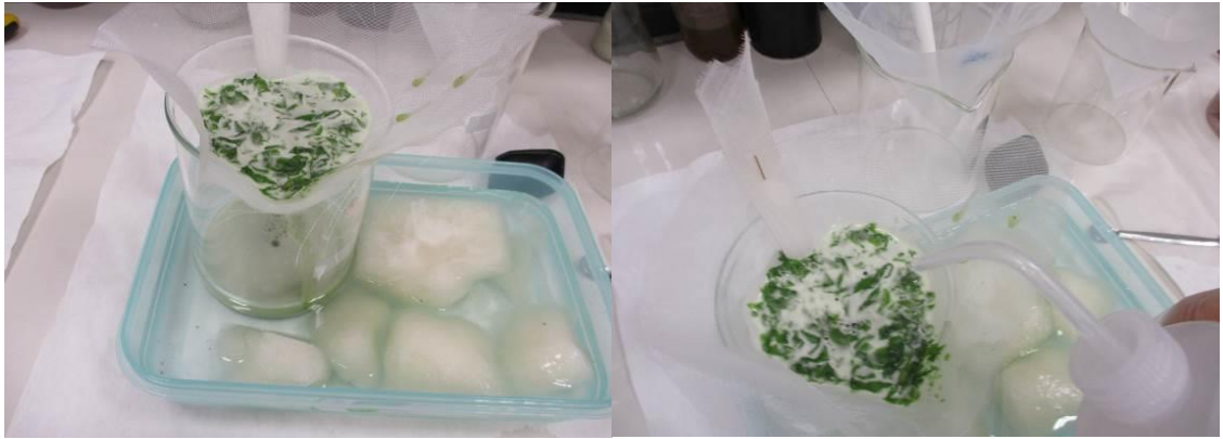
Şekil 3.5. Bead Beater'dan çıkarılan salgı tüyü izolasyon tamponu ve yaprak karışımının 350 \mu m gözenek açıklığına sahip filtreden süzülmesi ve yaprakların uzaklaştırılması.
