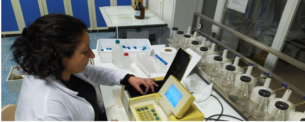
Şekil. 3.12. Çözelti absorbanslarının spektrofotometrik ölçümleri
