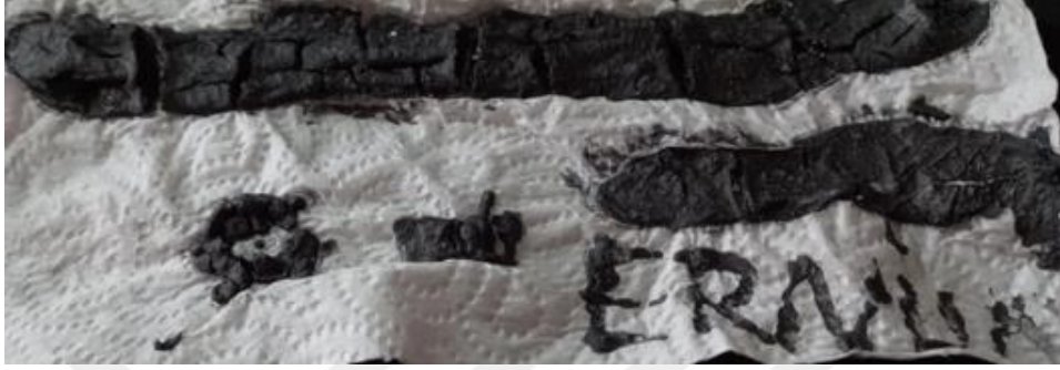
Şekil 4. 12. Grafit takviyeli numune ve baskı (grafit oranı %25).
