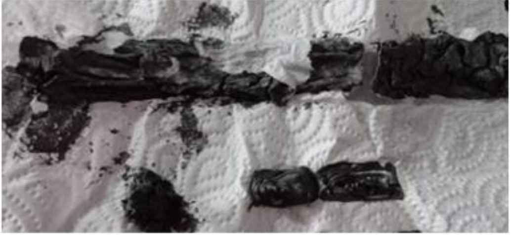
Şekil 4. 8. Grafit takviyeli numune ve baskı (grafit oranı %11,7).
