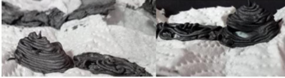
Şekil 5. 19. %11,7 grafit tozu takviyeli biyoplastiğin üç boyutlu yazıcıdaki çıktısı.
