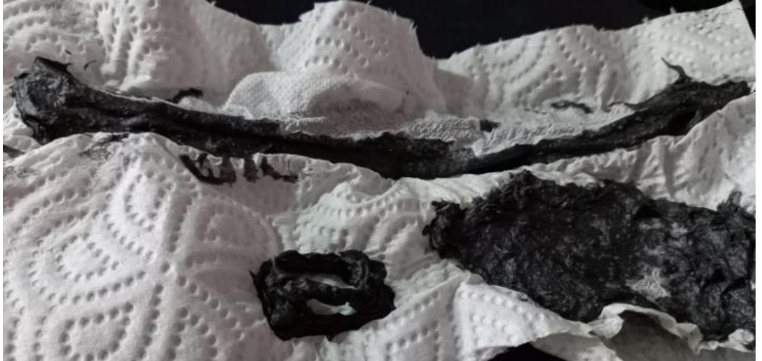
Şekil 4. 9. Grafit takviyeli numune ve baskı (grafit oranı %15, ince kum oranı %10).
