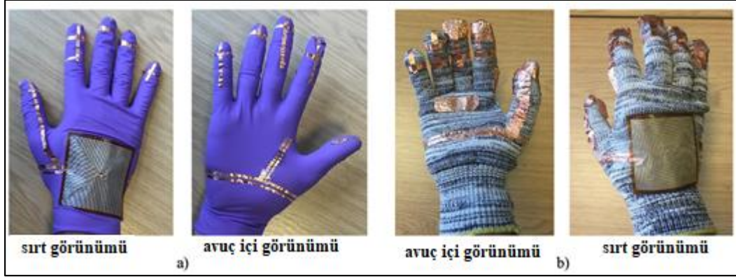
Şekil 2.14 Elektronik giyilebilir eldivenler kullanarak el hareketinin tespiti (Iervolino ve Meo, 2017)
