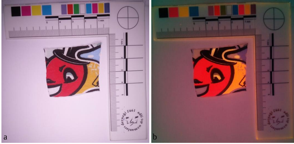
Resim 12. İdrar lekesi bulunan karışık renkli pamuk kumaş örneğinin beyaz ışık altındaki (a) ve 2.3 ışık seçeneği ve turuncu filtre ile alınan (b) görüntüleri
