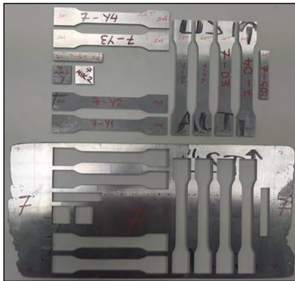
Şekil 3.22 : Üretilen Örnek Takoz Parça Levhası Test Numuneleri Resmi.
