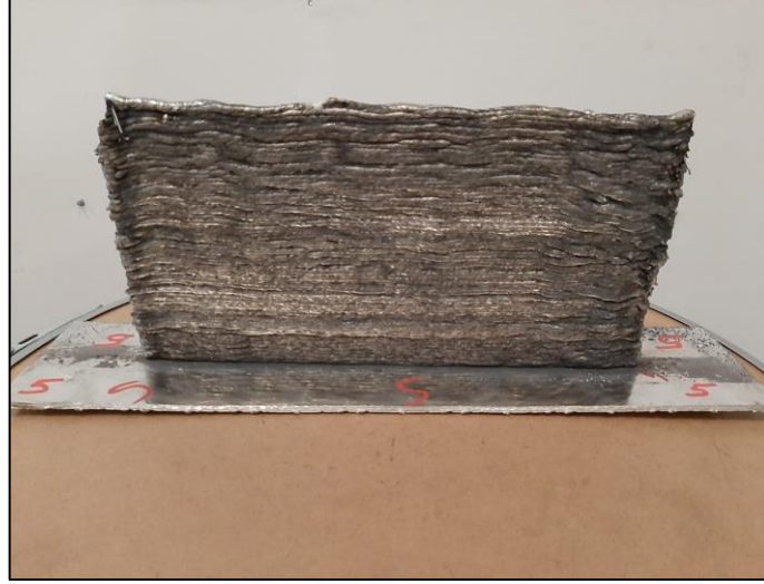
Şekil 3.11 : 5 Nolu Parametre Seti İle Üretilen Takoz Parça Resmi.
