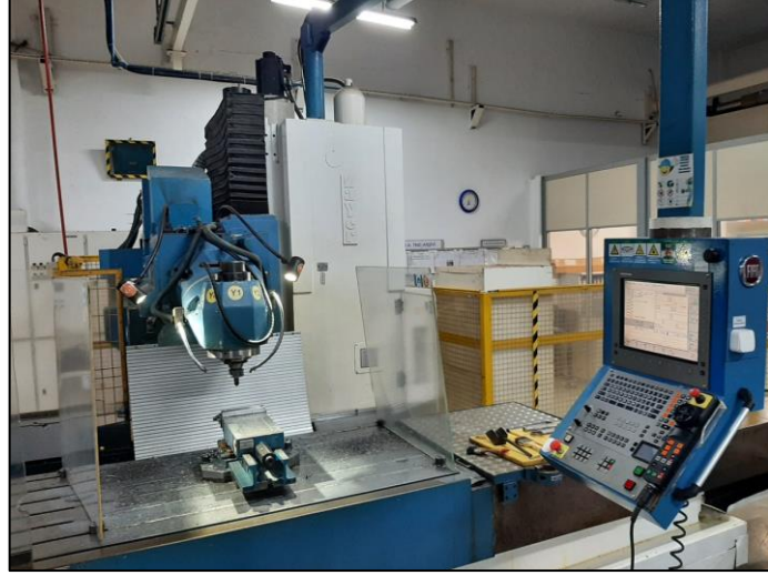
Şekil 3.16 : Zayer KF3000 Freze Makinası Resmi.
