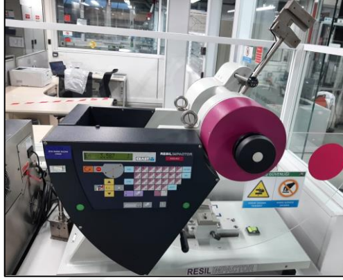
řekil 3.24 : Ceast Resil Impactor 9022 Test Makinası.
