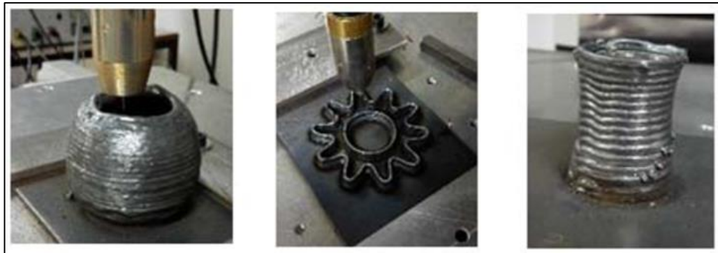
Şekil 2.14 : WAAM Metodu İle Üretilen Örnekler (Prado ve diğ., 2017).
