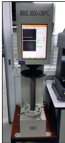
řekil 3.26 : BMS 3000-OBPC Sertlik Testi Makinası.
