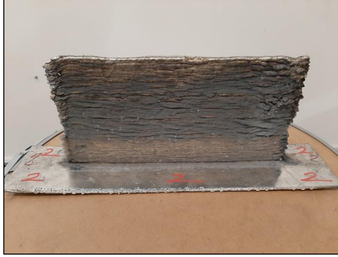
Şekil 3.8 : 2 Nolu Parametre Seti İle Üretilen Takoz Parça Resmi.
