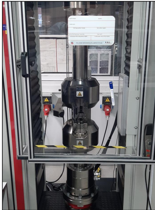
Şekil 3.23 : Zwick/Roell Z250 Çekme Testi Makina Resmi.
