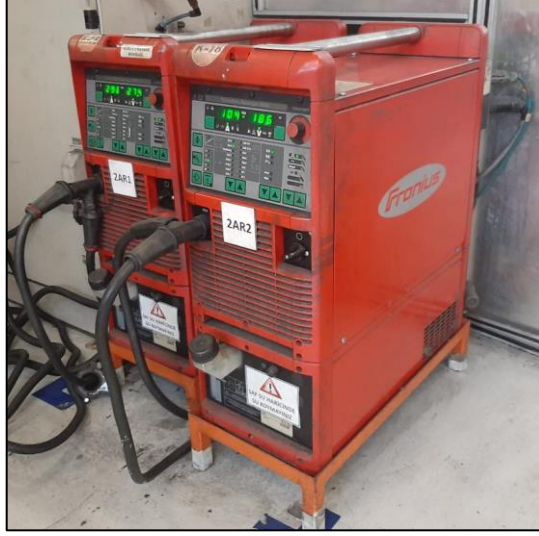
Şekil 3.3 : Fronius TransPuls Synergic 5000 Gazaltı Kaynak Makinası Resmi.
