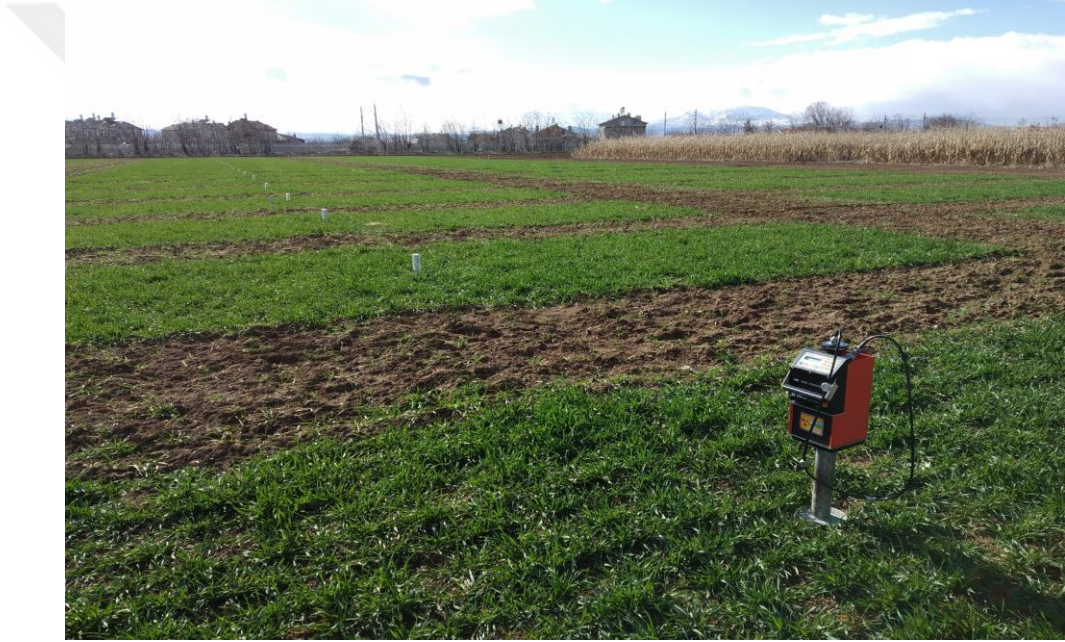
Şekil 3. 6. Nötronmetre ile toprak su içeriği ölçümü
