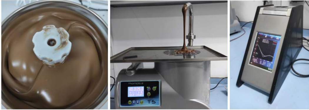
Şekil 3.2 Melanjördeki çikolata örneğinin sırasıyla temperleme ve tempermetre cihazına konulması
