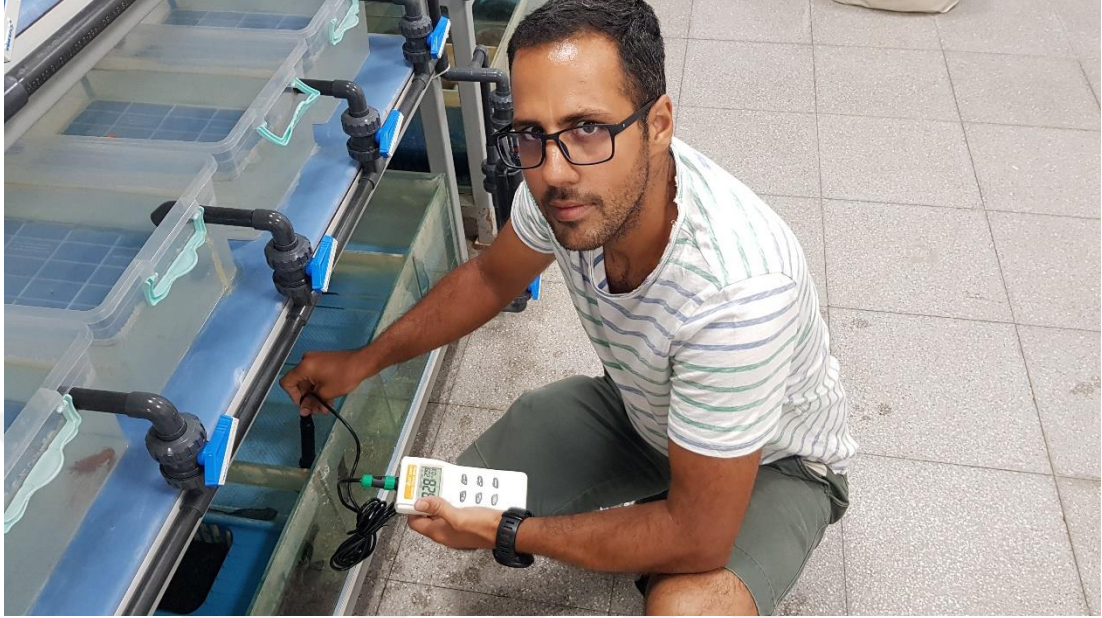
Şekil 4.4: Deneme sistemlerinde su parametreleri ölçümü
