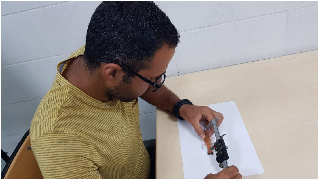
Şekil 4.6: Dijital kumpas ile total boy ölçümü
