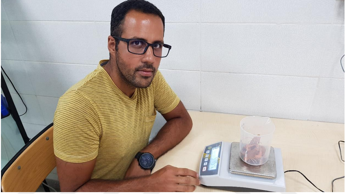
Şekil 4.5: Hassas terazi ile ağırlık ölçümü
