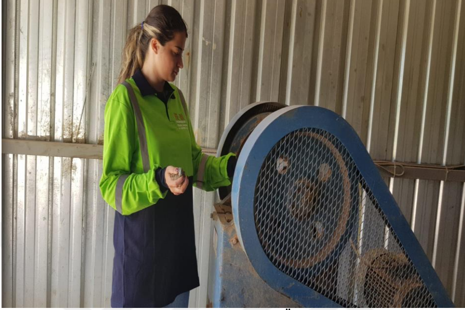
Şekil 3.6. Akmetal Madencilik (Kozan/Adana) Örnek Hazırlama Laboratuvarında örneklerin kırılması işlemi
