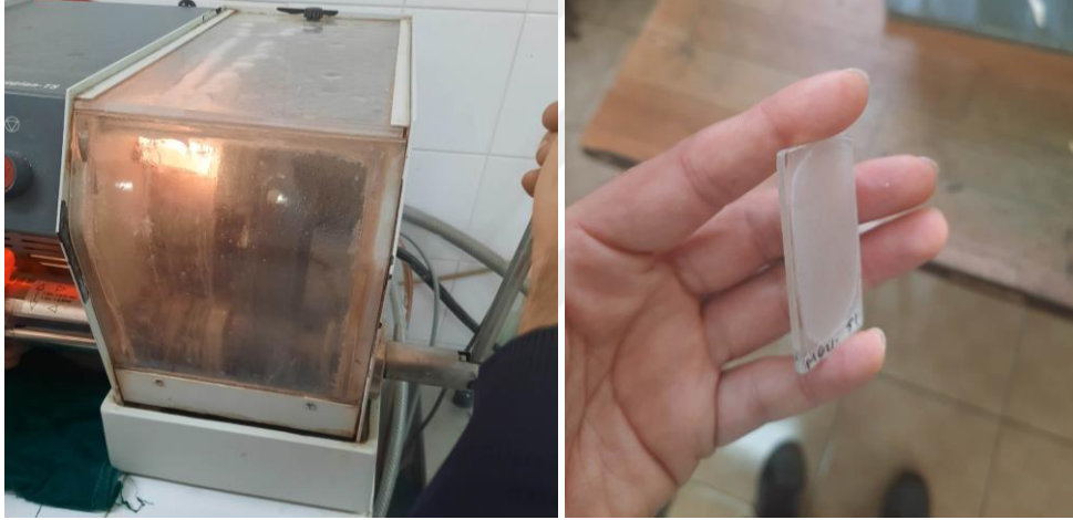
Şekil 3.4. Manuel aşındırma işlemi ve ince kesit için hazırlığı tamamlanan örnek
