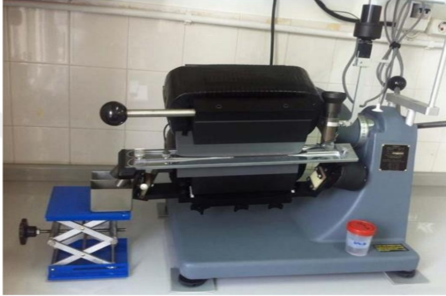
Şekil 3.9. Mineralleri manyetik ve manyetik olmayan fazlar olmak üzere iki gruba ayıran manyetik separatörün genel görünümü (Şimşek, 2018'den alınmıştır.)
