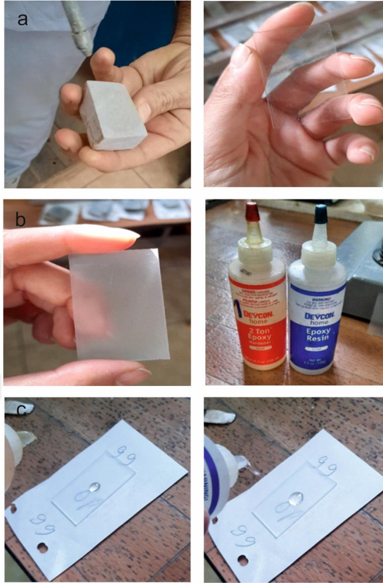
Şekil 3.2. Havalı kompresör ile kurutulan örnek ve düz cam lamel (a), bir yüzeyi pürüzleştirilmiş cam lamel ve cam lamellere örneklerin yapıştırılması için kullanılan epoxy sıvıları (b), cam lamel üzerine epoxy sıvıları damlatılarak solüsyon hazırlanması işlemi (c)
