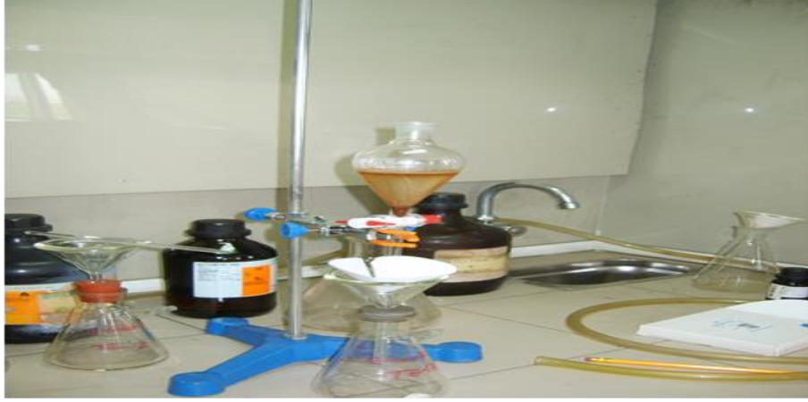
Şekil 3.10. Ağır sıvılar yardımı ile mineral ayırımı işlemi için oluşturulan düzeneğin görünümü
