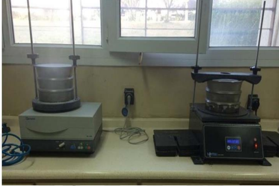
Şekil 3.7. Çukurova Üniversitesi Jeoloji Mühendisliği Bölümü örnek hazırlama laboratuvarında örneklerin elenmesi işlemi
