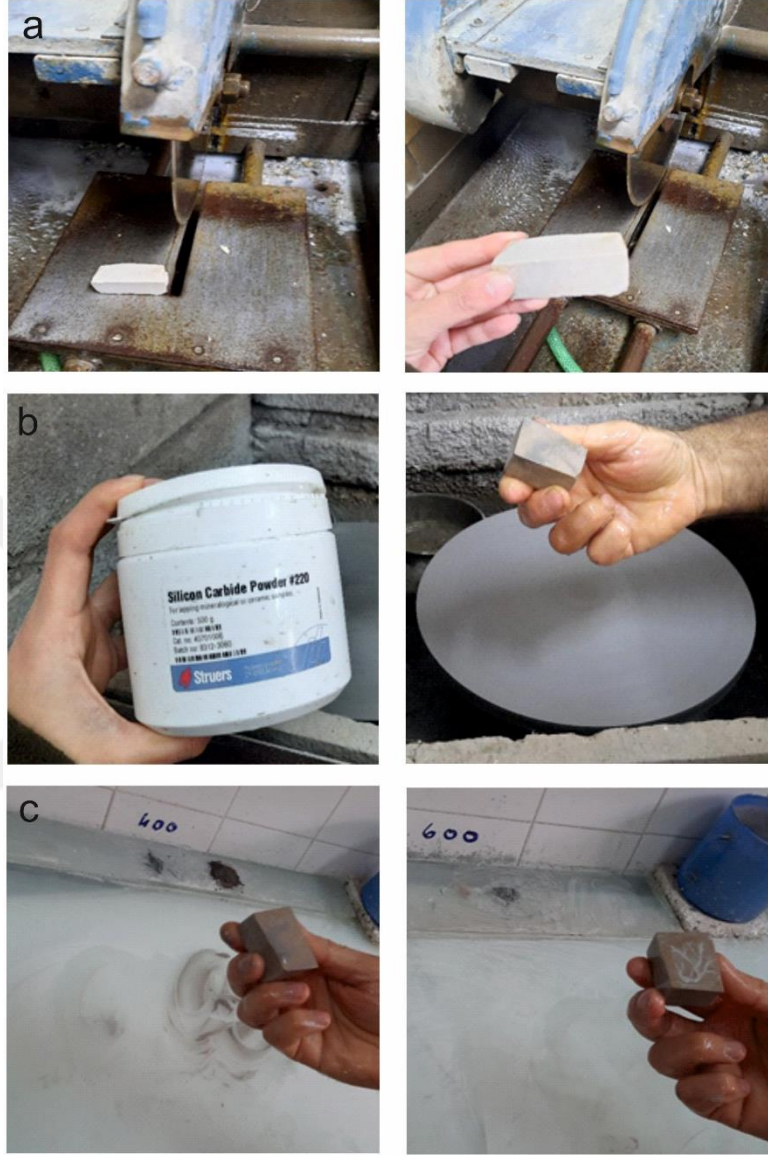
Şekil 3.1. Araziden derlenen örneklerin altere kısımlarından arındırılıp temizlenmesi ve yaklaşık dikdörtgen şekline getirilmesi işlemi (a), #220 Kalınlığında İnceltici Toz ve #220 kalınlıktaki en kalın aşındırıcı toz ile döner tabla üzerinde su yardımı ile pürüzsüzleştirilme işlemi (b), sırası ile #320 – #400 – #600 – #800 – #1000 kalınlıktaki aşındırıcı tozlar kullanılarak cam levha üzerinde pürüzsüzleştirilme işlemi (c)
