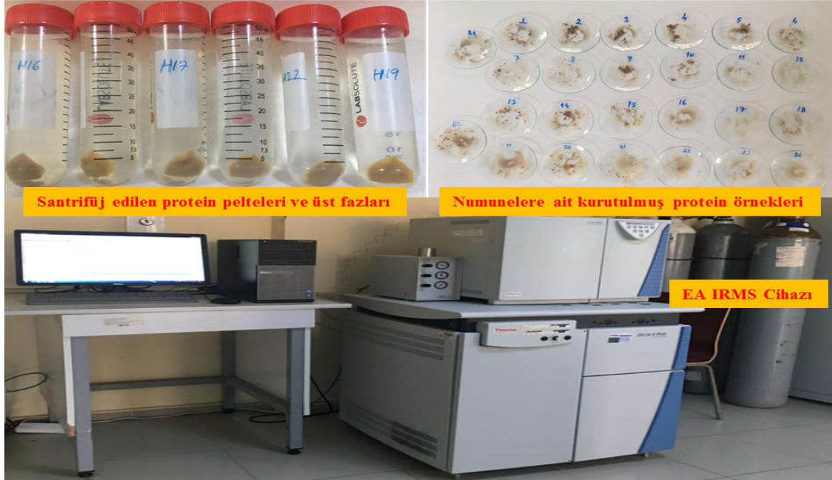
Şekil 11. EA IRMS cihazı ve numunelere ait çöktürülmüş ve kurutulmuş protein örnekleri
