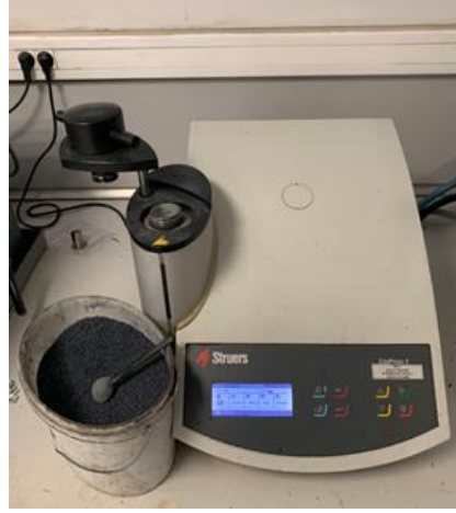
Şekil 5.9 : Struers marka CitoPress-1 modeli bakalit makinasının genel görünümü.
