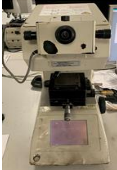
Şekil 5.16 : Shimadzu marka HMV-2 modeli mikro sertlik ölçüm cihazı genel görünümü.
