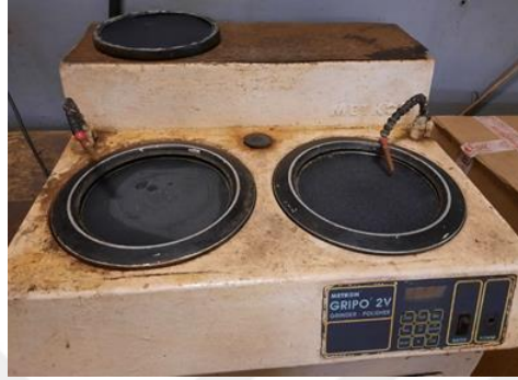
Şekil 5.13 : Metkon marka GRIPO 2V modeli zımpara ve parlatma makinasının genel görünümü.
