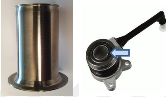
řekil 2.2 : Deneysel alıřmada kullanılan numunelerin fotoęrafı ve debriyaj aksamındaki bulunduęu yer.
