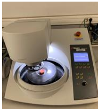
Şekil 5.14 : Struers marka Tegramin-25 modeli zımpara parlatma makinasının genel görünümü.
