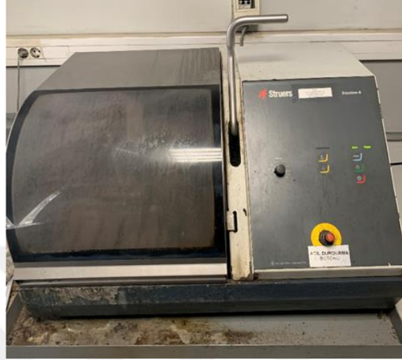
Şekil 5.7 : Struers marka Discotom-6 modeli kesme makinası genel görünümü.
