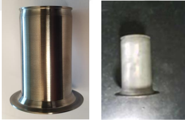
Şekil 5.6 : Nitrokarbürleme öncesi ve sonrası numune fotoğrafı.
