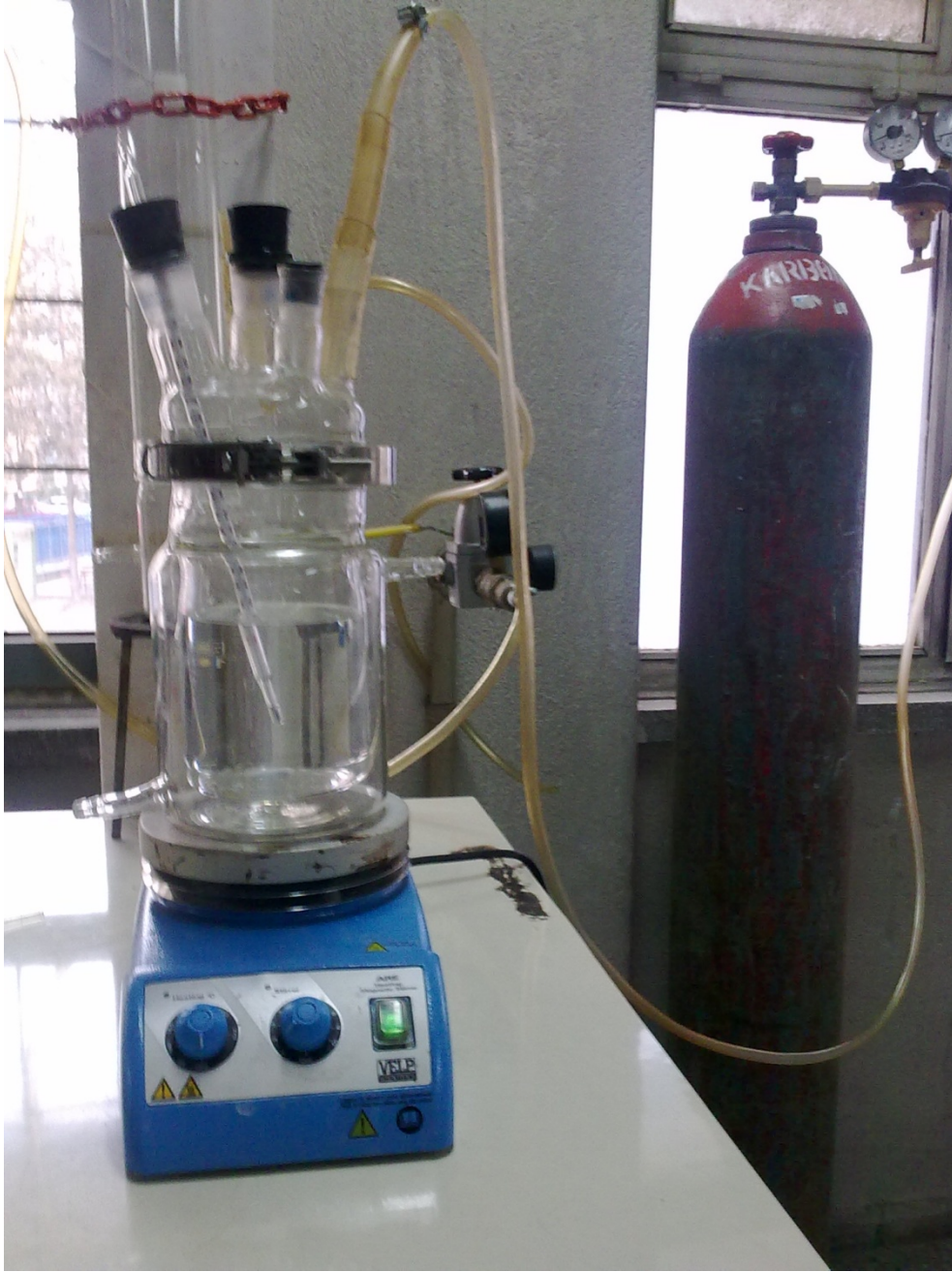
Resim 6.1. Sodyum metaborat – CO 2 reaksiyonunun kinetik çalışmasının yapıldığı deney düzeneği
