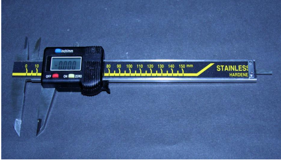
Şekil 9. Ölçümlerde kullandığımız digital kumpas
