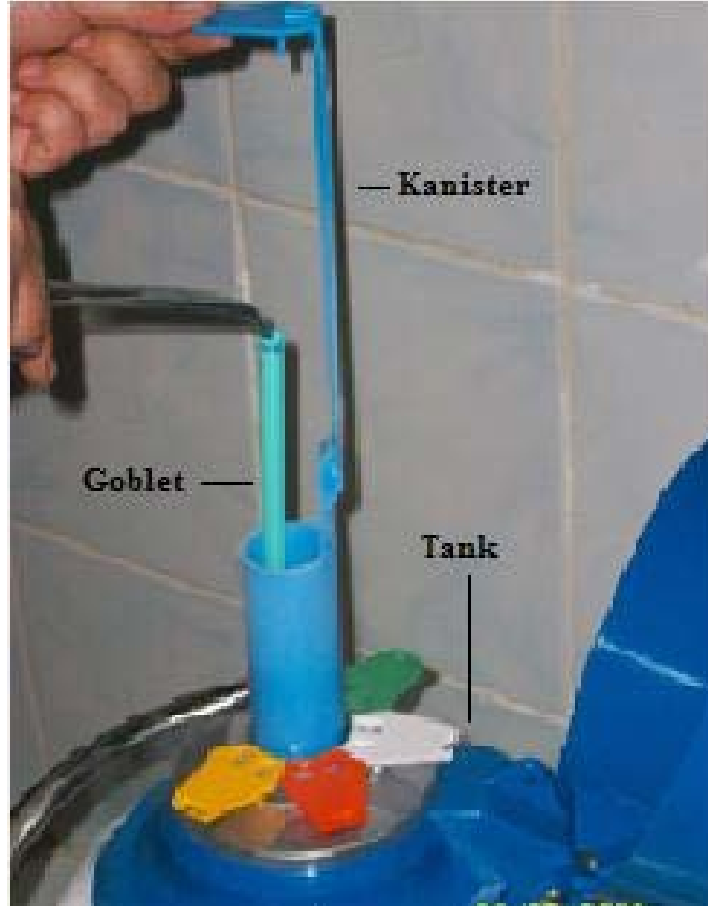
Şekil 3.17: Payetlerin yerleştirildiği goblet, kanister ve sıvı azot tankının görünümü
