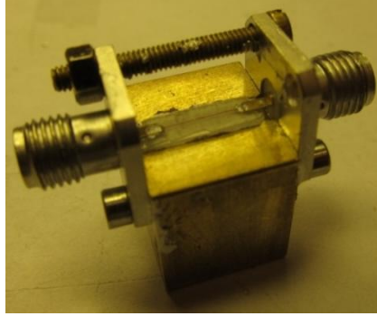
Şekil 6.4 Prinç küp üzerine monte edilmiş mikro şerit
