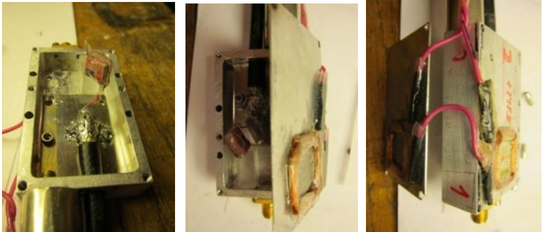
Şekil 6.3 Selenoidal sarımın içine yerleştirildiği kutu ve kutunun üstüne monte edilen modülasyon sarımları
