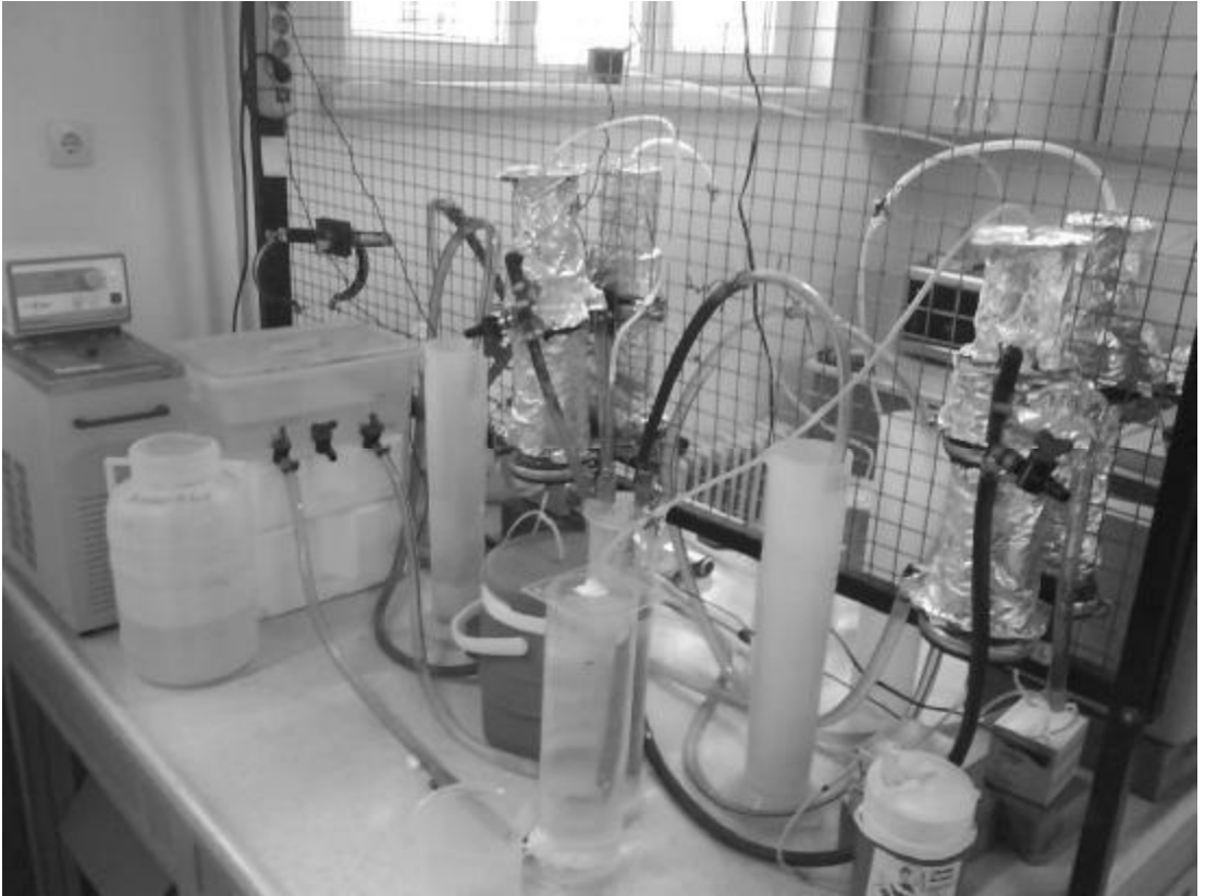
Şekil 3.3. YAÇY reaktörleri kullanılan laboratuvar ölçekli anaerobik arıtma düzeneği
