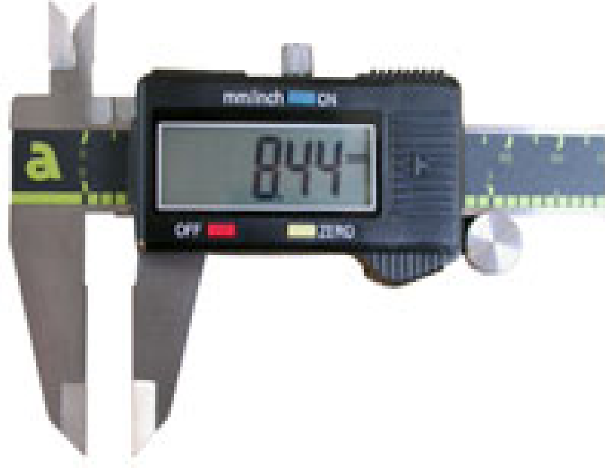
Şekil 1: Parmak uzunluklarını ölçmek için kullanılan 0.01 mm hassasiyetli dijital kumpas.
