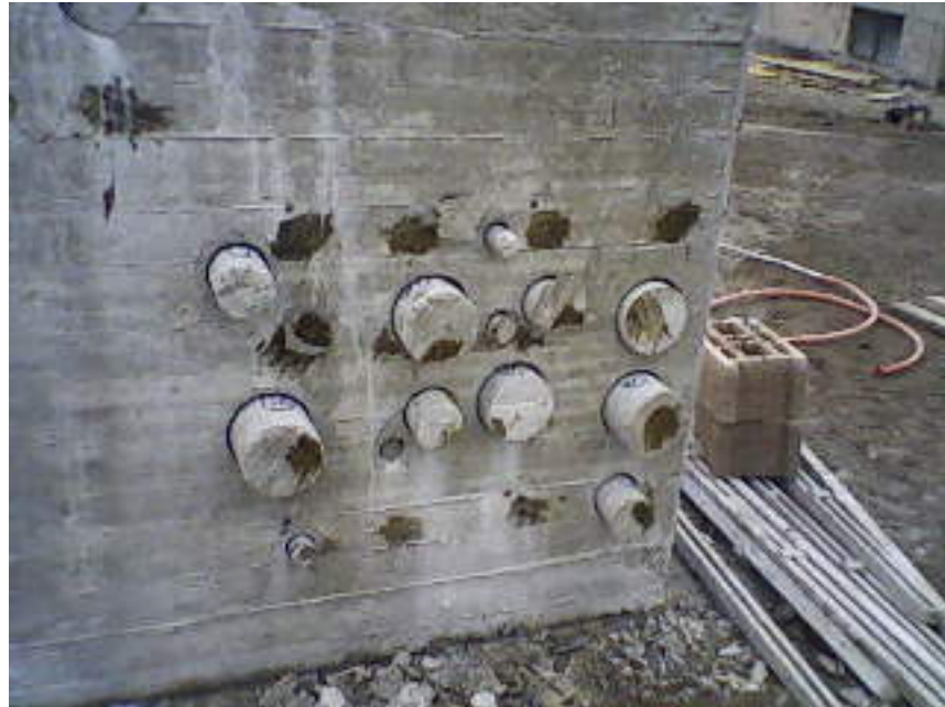
Şekil 5.17. Perde elemanında kuzey yönündeki alınan karotların dışında kesim esnasında dairesel parçalanmalar gözükmedi.
