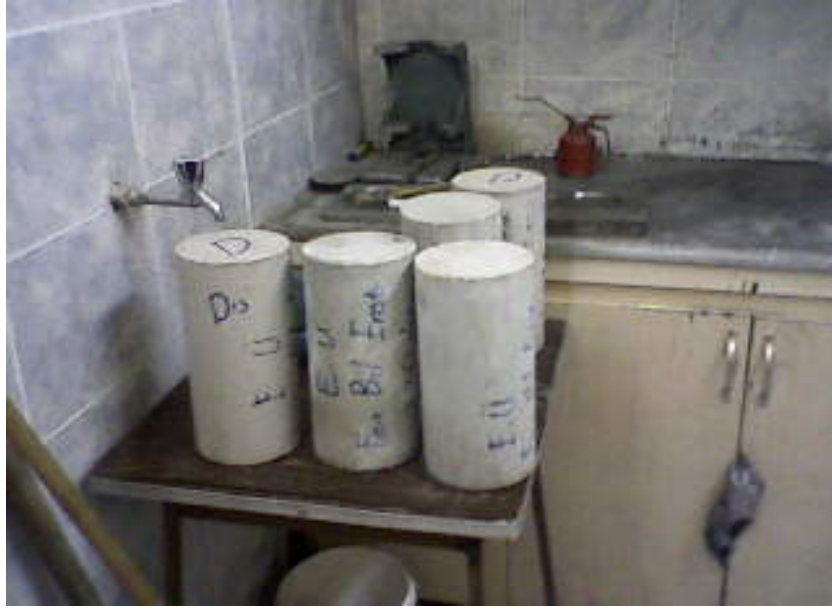
Şekil 5.12. Üç adet silindir numunesi ERÜ İnş. Müh. Bölümü Yapı Malzemeleri Laboratuvarının kür havuzunda bekletilmiş ve iki adet dış çevre koşullarına bırakılan numuneler başlık yapılmadan önce.
