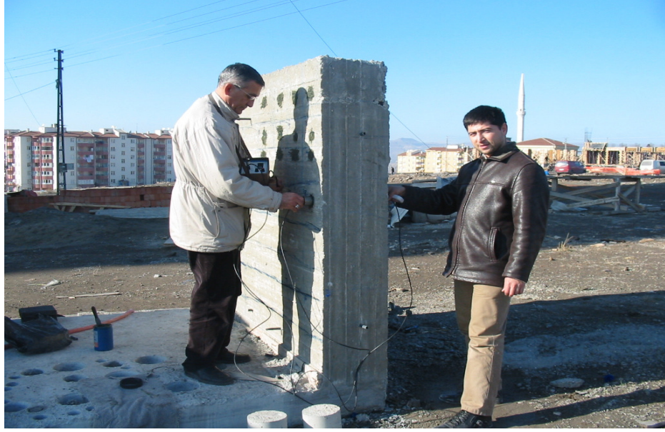
Şekil 3.1. Prof. Dr. Tefaruk Haktanır ile ultrases dalga hızı ölçümü yaparken.
