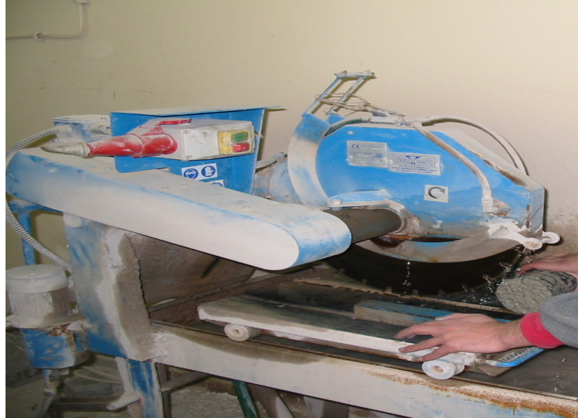
Şekil 5.19. Taş kesme makinesinde bir karotun yüzeylerinin tıraşlanması.
