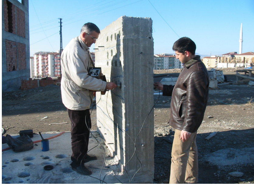
Şekil 5.29. Pundit cihazı ile perde betonu içinden ultrasonik hız okunması.
