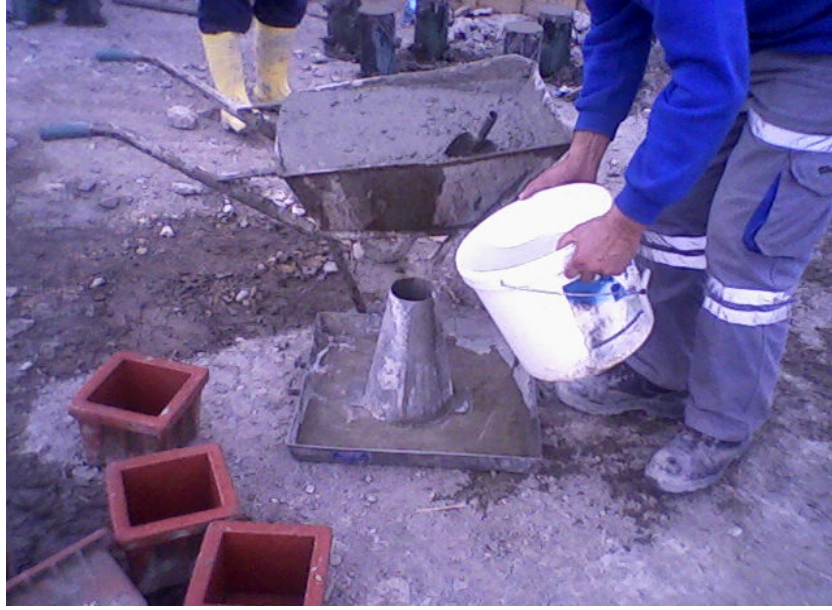
Şekil 5.7. Çökme (slamp) deneyine başlarken yapılan temizlik.
