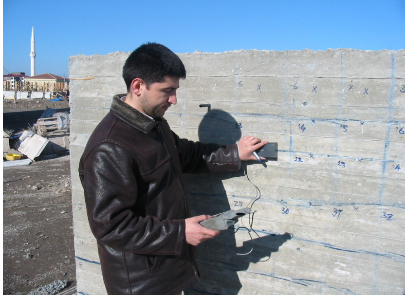
Şekil 5.15. Karot alınmazdan evvel ferroskan (paşometre) cihazıyla enine ve boyuna donatıların yerlerinin tespiti
