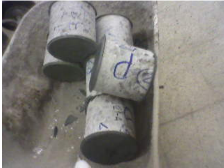
Şekil 5.27. 15cm çaplı farklı boy/çap oranındaki bazı karotların kırılmadan sonraki görünüşü.
