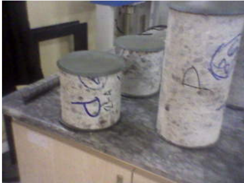
Şekil 5.23. 15cm çaplı boy/çap oranları 1, 1.5 ve 2 olan perde karot numunelerden bazıları.
