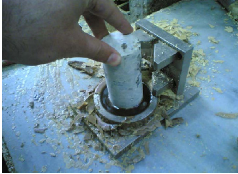
Şekil 5.20. Taş kesme makinesinde kesilip uçları düzenlenen 5cm çaplı karot numunenin kükürt+grafit tozu eriyiği ile başlık yapılması.
