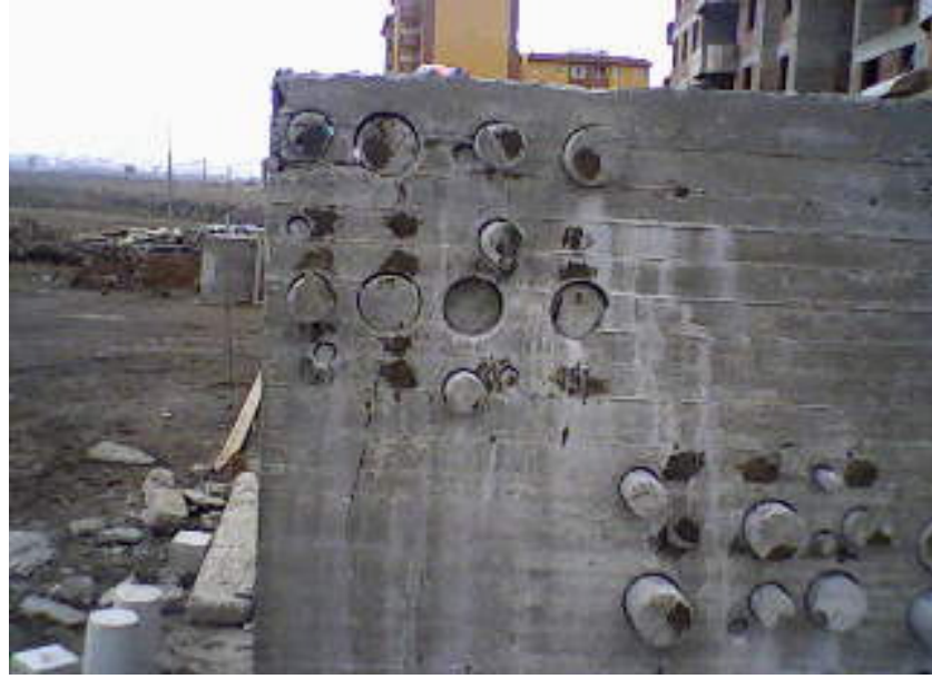
Şekil 5.16. Perde elemanı dört parçaya ayrılarak karşılıklı iki parçadan alınan 5cm, 10cm ve 15cm çaplı karotlar.
