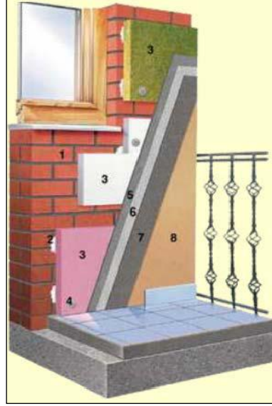
Şekil 4.11. Levha halindeki ısı yalıtım malzemelerinin duvara uygulanışı (Akıncı, 2007)
