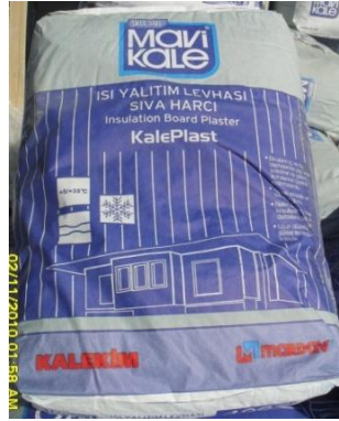
Şekil 4.6. Isı yalıtım levhalarının dış katmanına uygulanan sıva harcı
