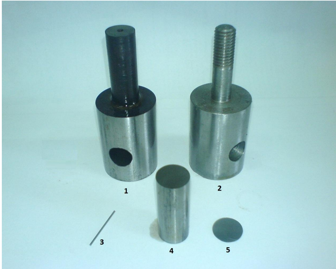
Şekil 3.7. Mekanik deneylerde kullanılacak çelik aperlara ve titanyum numunelere ait görüntü.
