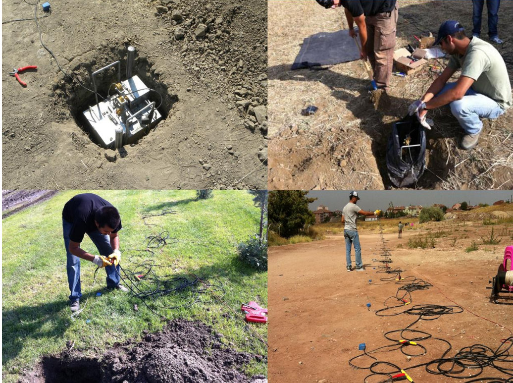
Şekil 4.13 Sismik kırılma çalışması sırasında çekilen fotoğraflar
