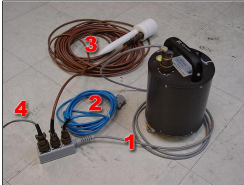
Şekil 4.10 Çalışmada kullanılan Guralp CMG-6TD ölçüm cihazı ve ekipmanları
