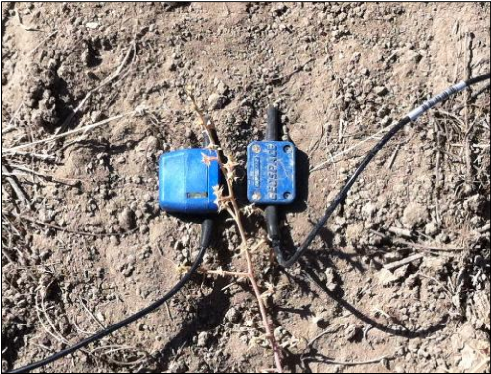
Şekil 4.9 S jeofonu (solda) ve P jeofonu (sağda)
