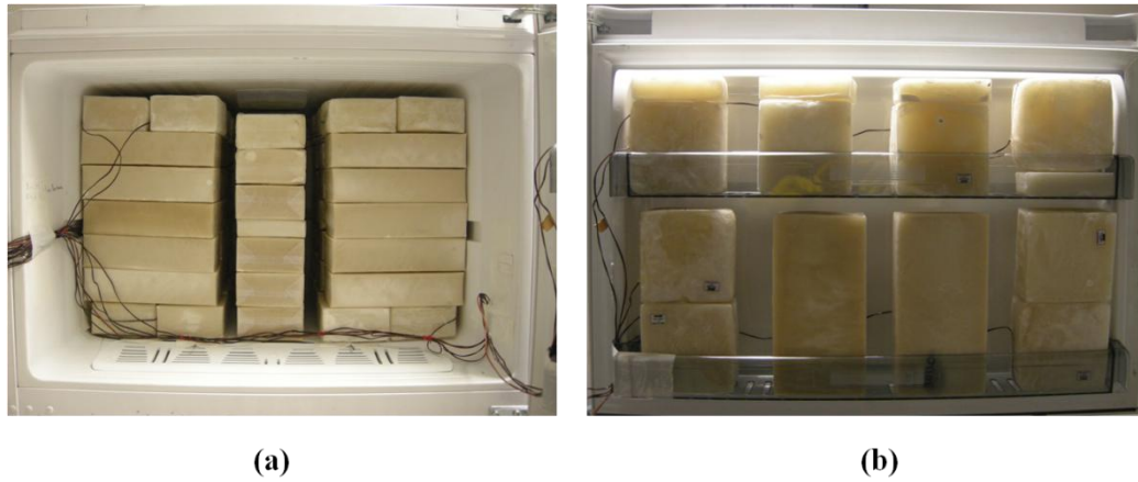
Şekil 3.6 : Dondurucuda (a) kabin ve (b) kapıya yüklenen paketler.
