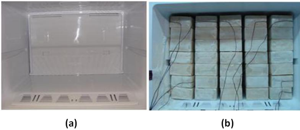
Şekil 2.11: Dondurucu bölmenin (a) boş ve (b) paket yüklü durumu.
