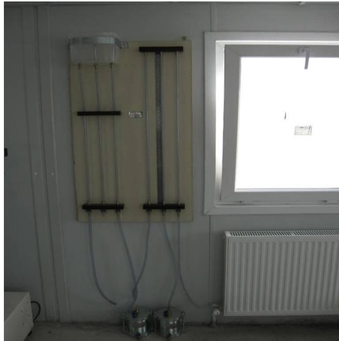
Resim 2.26 Düşen Seviyeli Permeabilite testi seti, YM laboratuvarı, 2009
