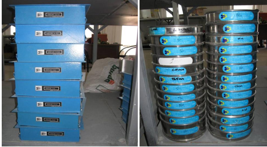
Resim 2.12, 2.13 Projede kullanılan yassılık elek takımı, Yapı Merkezi laboratuvarı 2010
