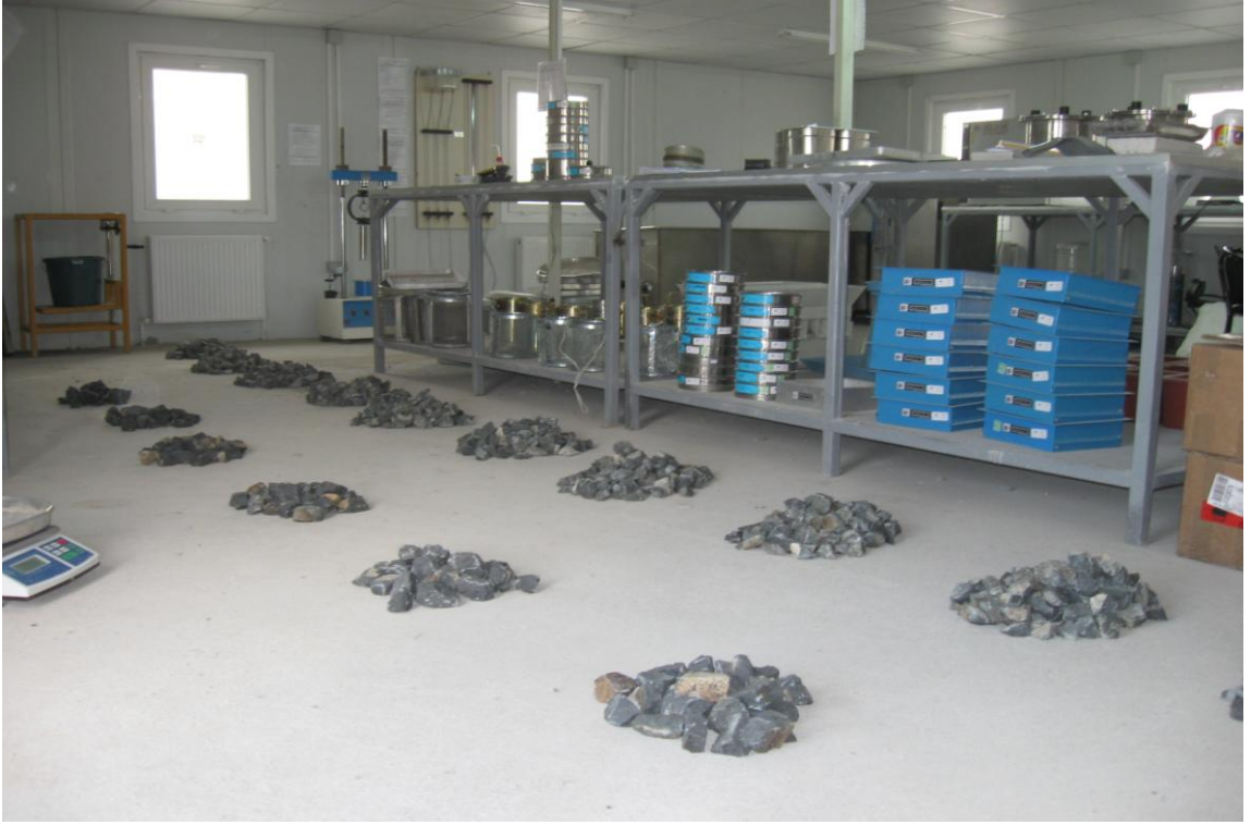
Resim 3.23 Hacituğrul ocağından alınan numunelerin losangellers, deval ve magnezyum testleri için hazır hale getirilmesi, YM laboratuvarı, 2010
