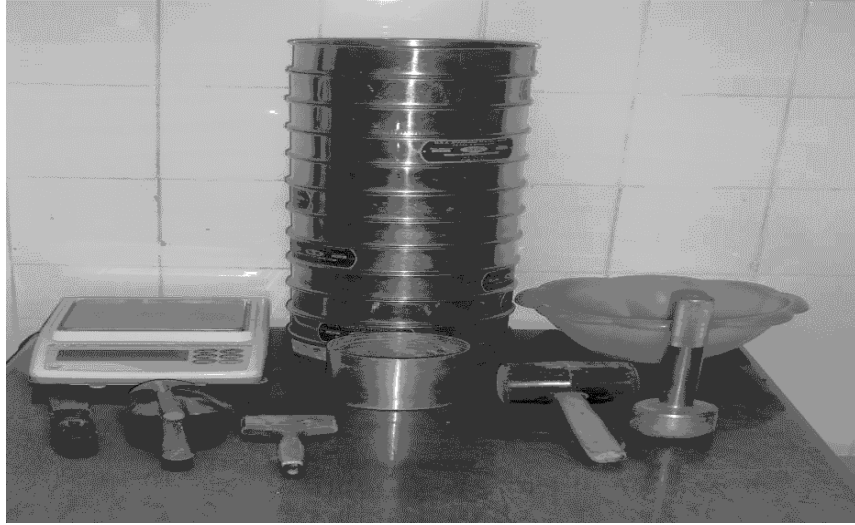
Resim 2.10 Elek analizi için gerekli olan araç ve gereçler
