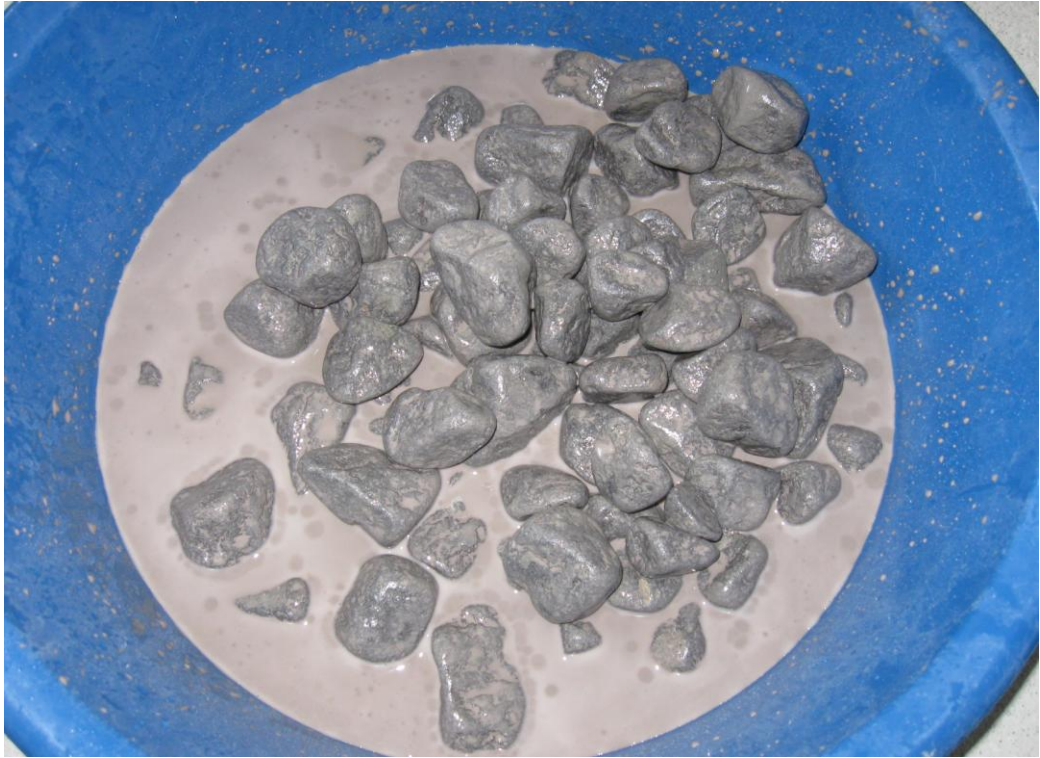
Resim 4.4 Hacituğrul ocağına ait numune üzerinde yapılan 1000 devirlik losangeles deneyi sonrası yıkanan numune, 2010
