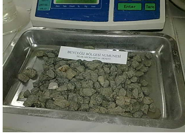
Resim 4.3 Beyceğiz numunesi micro_deval testi sonrası sonuç alınacak haldeki numune, 2010
