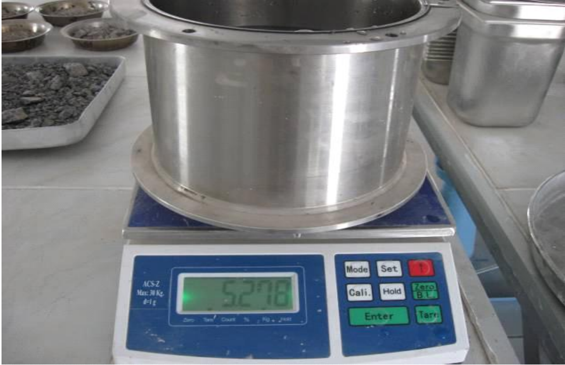
Resim 2.30 Micro_Deval tanbur ağırlığı alınırken, Yapı Merkezi laboratuvarı, 2010
