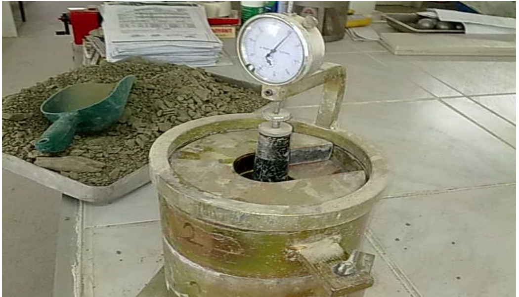
Resim 4.9 Hacituğrul ocağına ait numunenin CBR testi için mold ve saat düzenini kurulması, 2010
