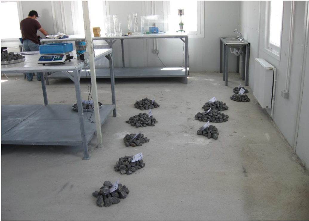
Resim 3.6 Losangeles aşınma testi için hazırlanan numuneler
