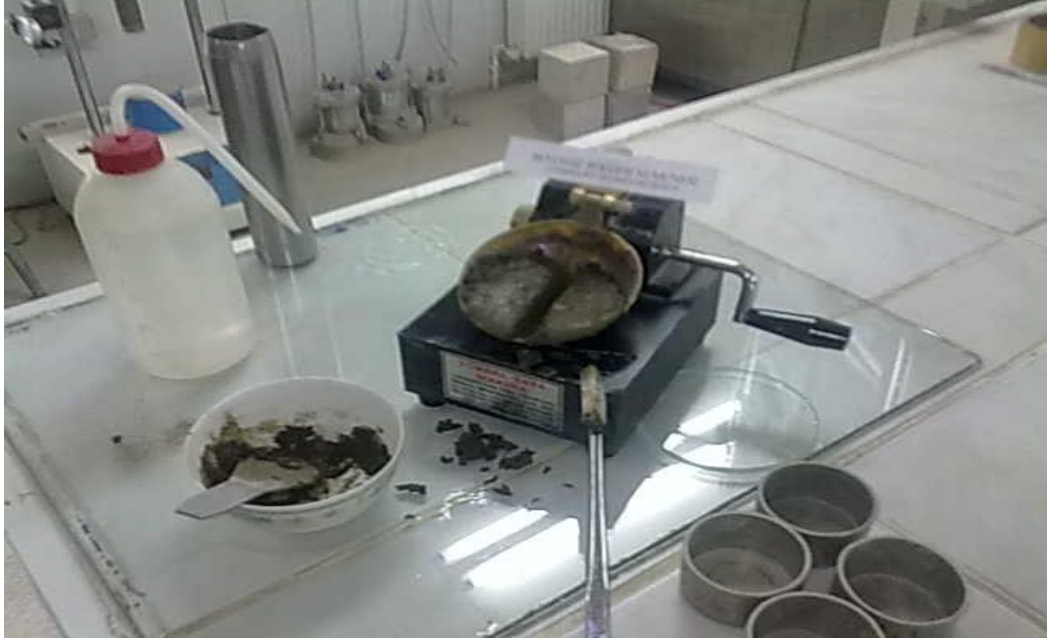
Resim 4.11 Şabanözü agregaları atterberg kıvam limitleri deneyi, 2010
