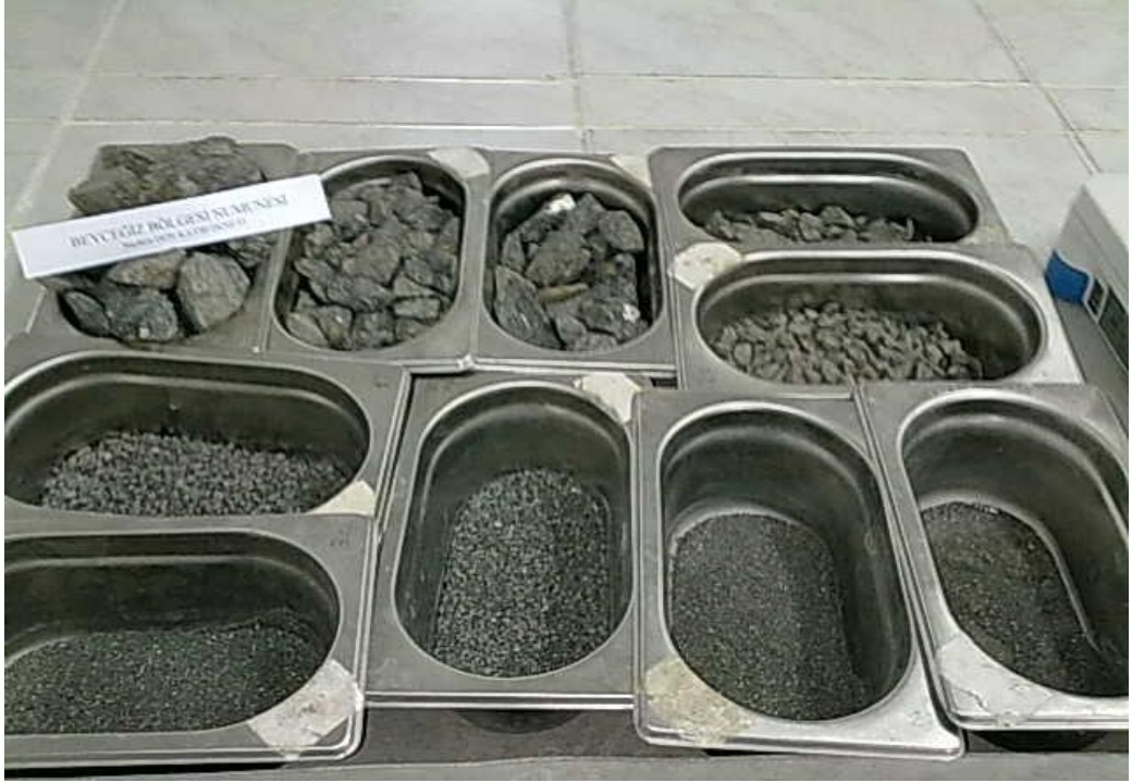
Resim 4.6 Beyceğiz ocağına ait numuneler sodyum-sülfatlı don kaybı testi için hazırlanmış bir örnek resim, YM laboratuvarı, 2010
