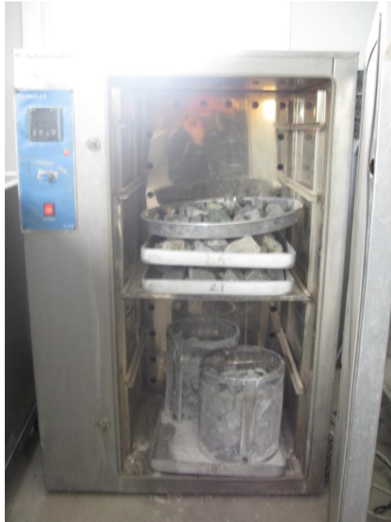
Resim 3.24 Hacituğrul ocağı numuneleri için devam eden magnezyum ve su emme testleri, YM laboratuvarı, 2010
