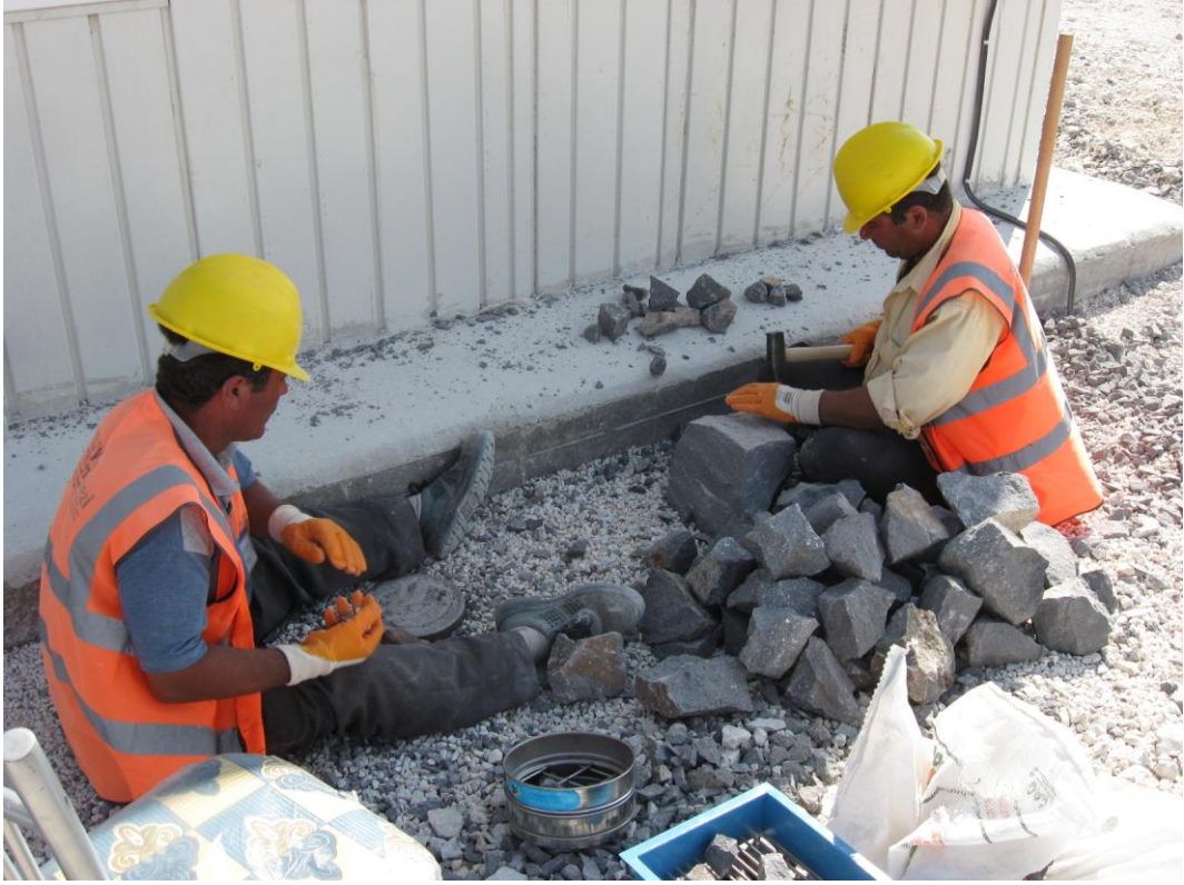
Resim 3.3 Şabanözünden alınan numunelerin elden kırılarak hazırlanması
