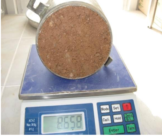
Resim 2.23 CBR testinden bir görüntü, YM laboratuvarı, 2010
