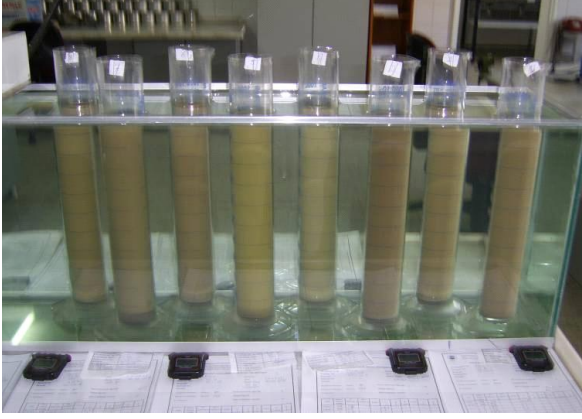
Resim 2.15 Hidrometre deneyine bir örnek, anonim 2010
