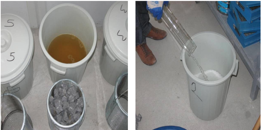
Resim 2.35, 2.36 Magnezyum sülfat deneyi için hazırlanan numuneler ve çözelti
