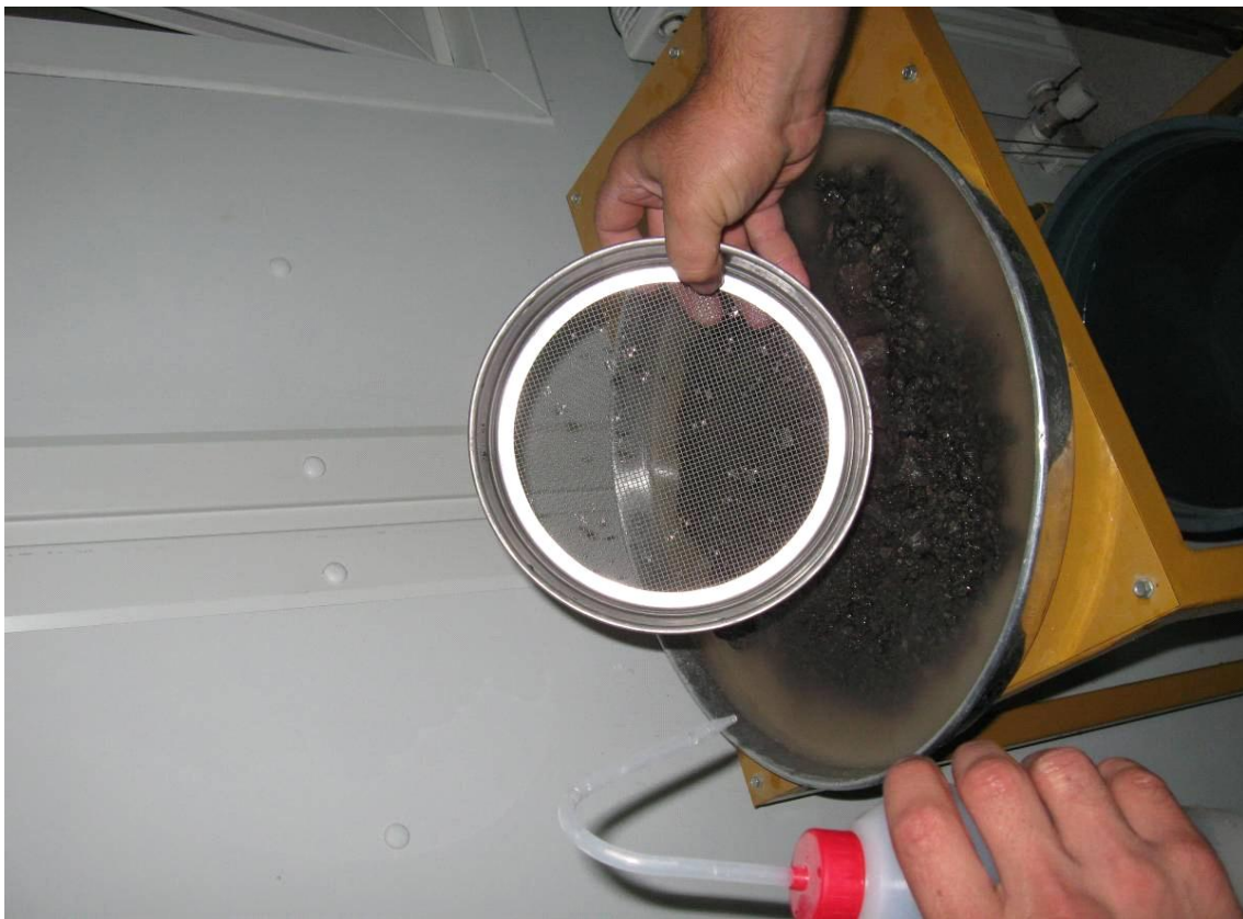
Resim 2.40 Kil topakları testinden yıkama esnasında çekilen bir görüntü, 2010
