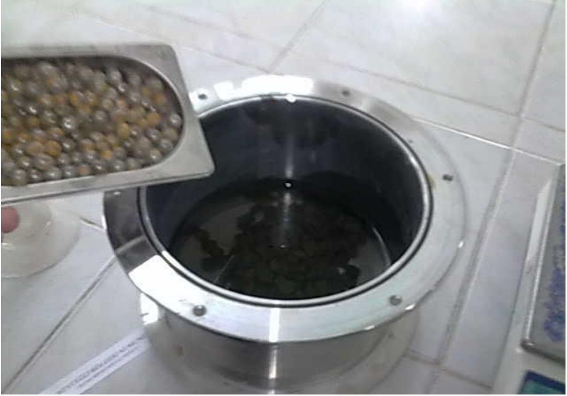
Resim 3.16-1 Micro_Deval testi döndürme öncesi numune hazırlanması, YM laboratuvarı 2010
