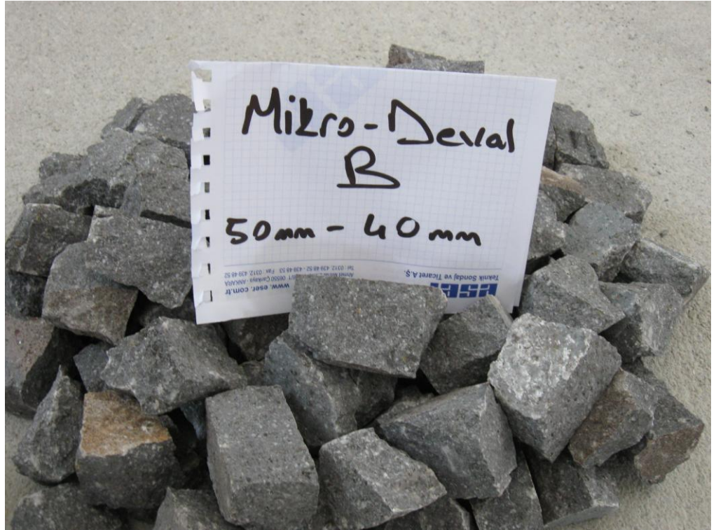
Resim 3.5 Micro_Deval testi için hazırlanan numuneler
