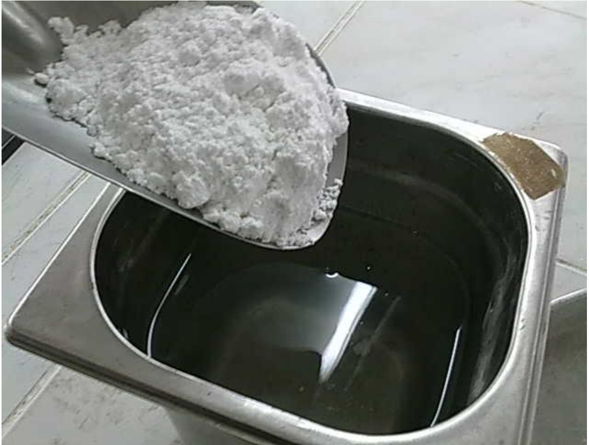
Resim 2.39 Sodyum-sülfatlı don kaybı deneyi için hazırlanan çözeltilerden örnek, 2010
