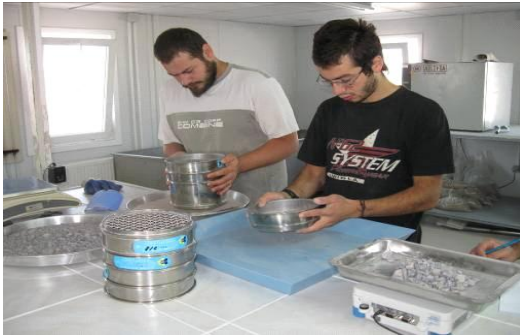
Resim 2.11, 2.12 Elek analizi yapımı, Yapı Merkezi laboratuvarı, 2010
