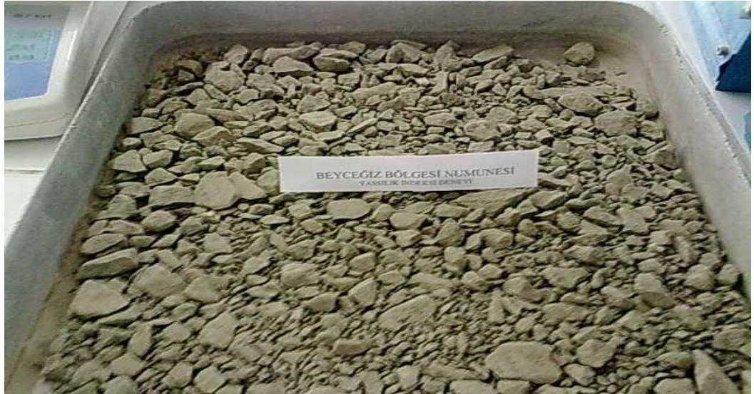
Resim 3.12 Yassılık indeksi tayini için hazırlanan beyceğiz numunesi
