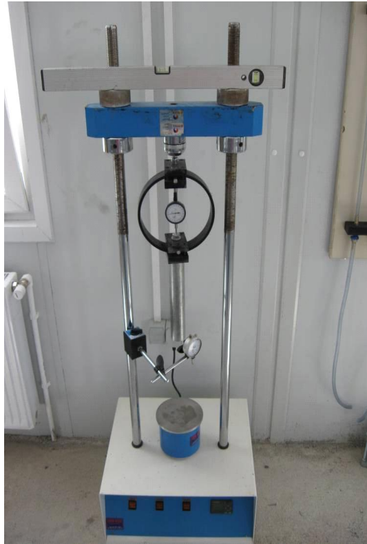
Resim 2.22 Yapı Merkezi laboratuvarında tez için kullanılan manuel CBR cihazı, 2010
