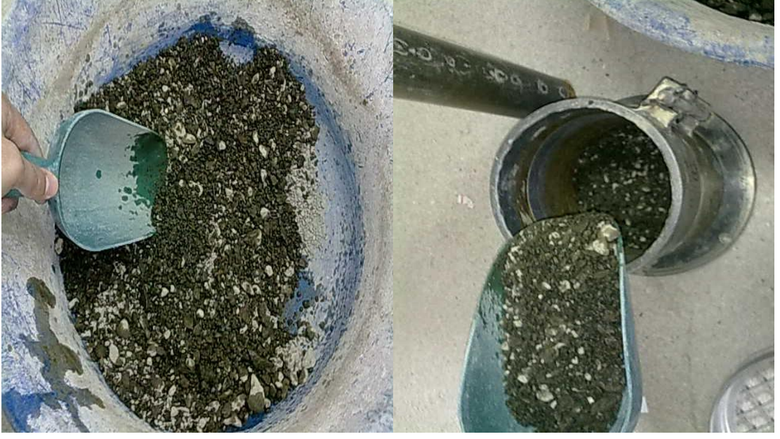
Resim 3.15 Beyceğiz numunesi proktor testi örnek resim
