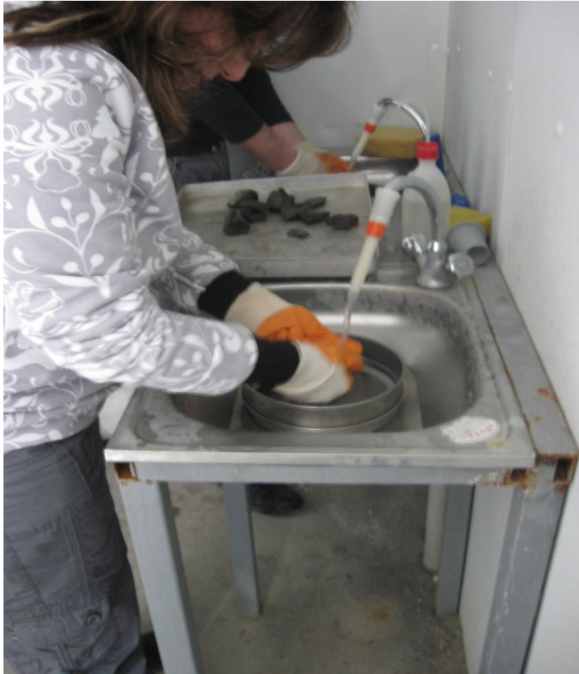
Resim 3.19 Beyceğiz numunesi ince ve çok ince madde tayini testi yıkama aşaması, YM laboratuvarı 2010
