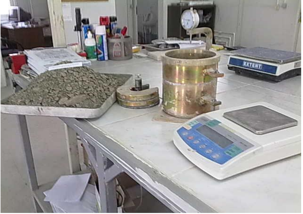
Resim 3.27 Hacıtuğrul ocağına ait numuneler üzerinde yapılmak istenen cbr testi öncesi hazırlanan numune, 2011
