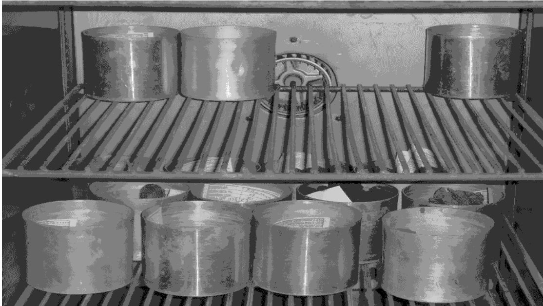
Resim 2.1 Su içeriği belirlenecek numunelerin etüvde kurutulması
