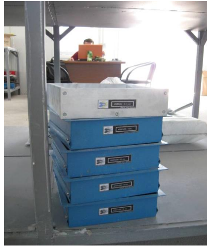
Resim 2.14 Yassılık elek takımı, Yapı Merkezi laboratuvarı 2010
