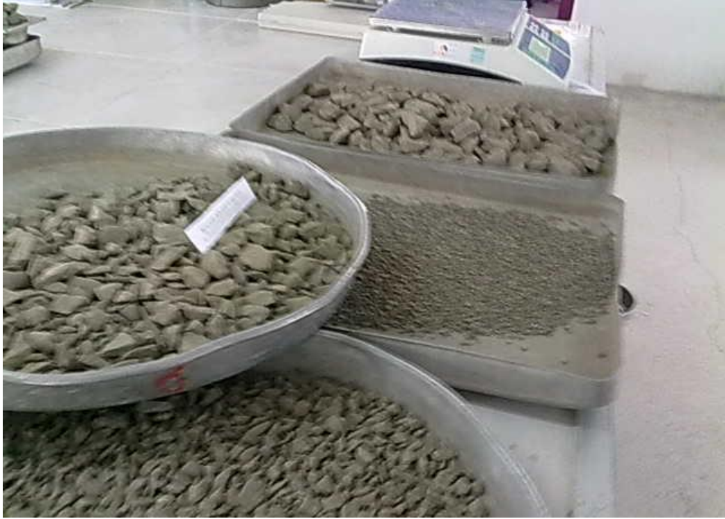
Resim 4.12 Beyceğiz ocağına ait numuneler üzerinde yapılan kil topları testi için hazırlanmış olan numuneler, 2010
