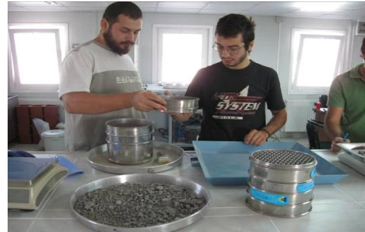
Resim 2.11, 2.12 Elek analizi yapımı, Yapı Merkezi laboratuvarı, 2010
