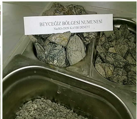
Resim 3.14 Sodyum don kaybı testi örnek resim
