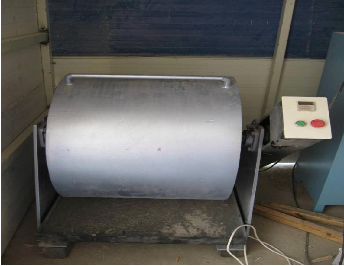
Resim 2.32 Losangeles cihazı Yapı Merkezi laboratuvarı, 2009
