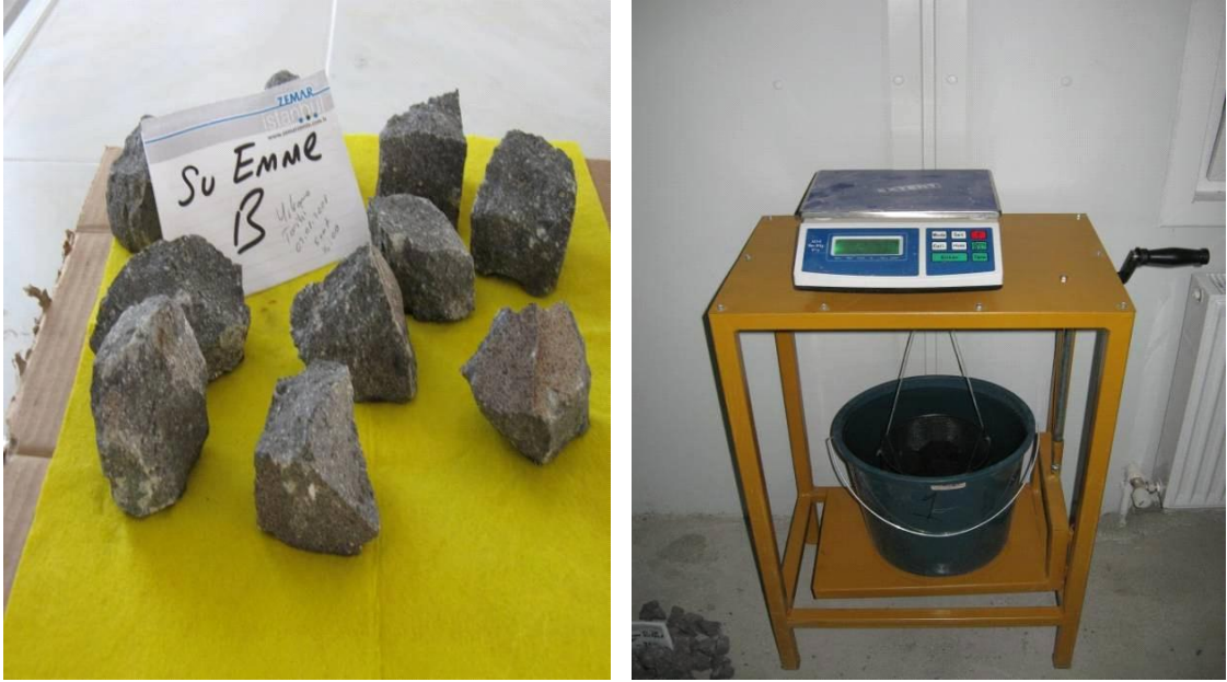
Resim 2.37 ve 2.38 Su emme tel sepeti deneyi için gerekli düzenek ve hazırlanan numuneler, 2010
