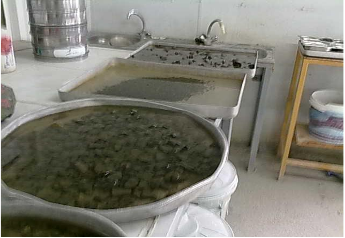
Resim 3.16 Beyceğiz numunesi kil topakları ve dağılıbilen malzeme oranı tayini, YM laboratuvarı, 2010
