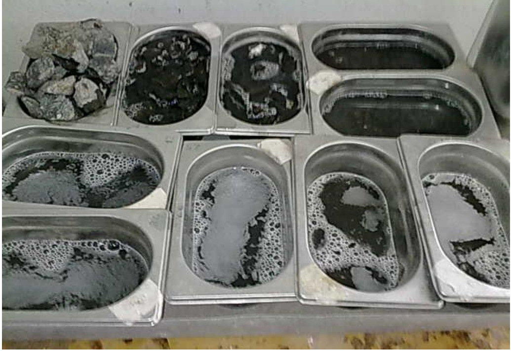
Resim 4.7 Sodyum-Sülfat çözeltisine mağruz bırakılan şabanözü numuneleri, 2010
