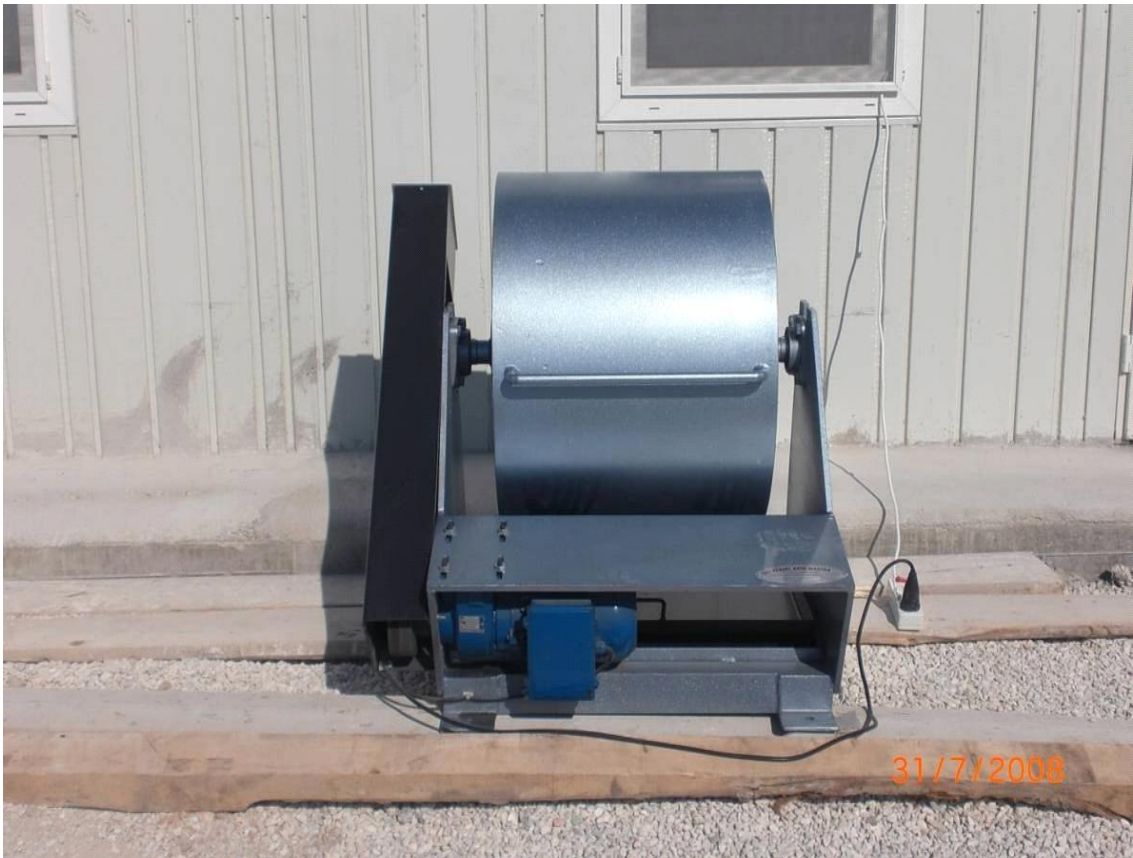
Resim 2.31 Losangeles cihazı, Yapı Merkezi laboratuvarı, 2008
