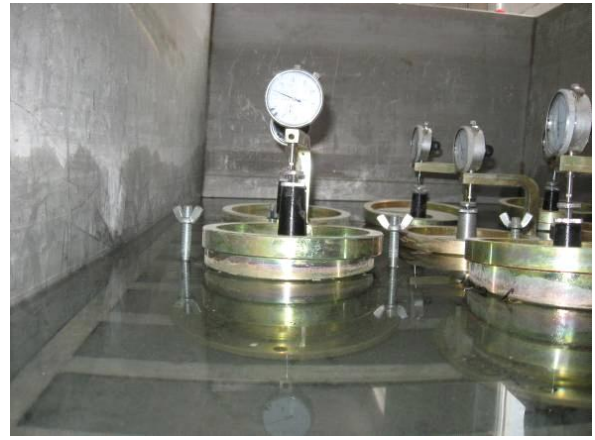
Resim 2.24 CBR testinden bir görüntü, YM laboratuvarı, 2010
