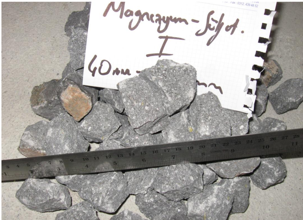
Resim 3.7 Magnezyum-sülfat don kaybı testi öncesi
