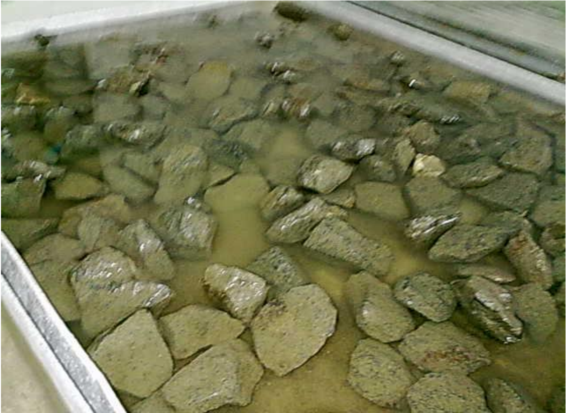
Resim 3.26 Hacituğrul ocağına ait numuneler üzerinde yapılan kil topakları testinden bir görüntü, 2010
