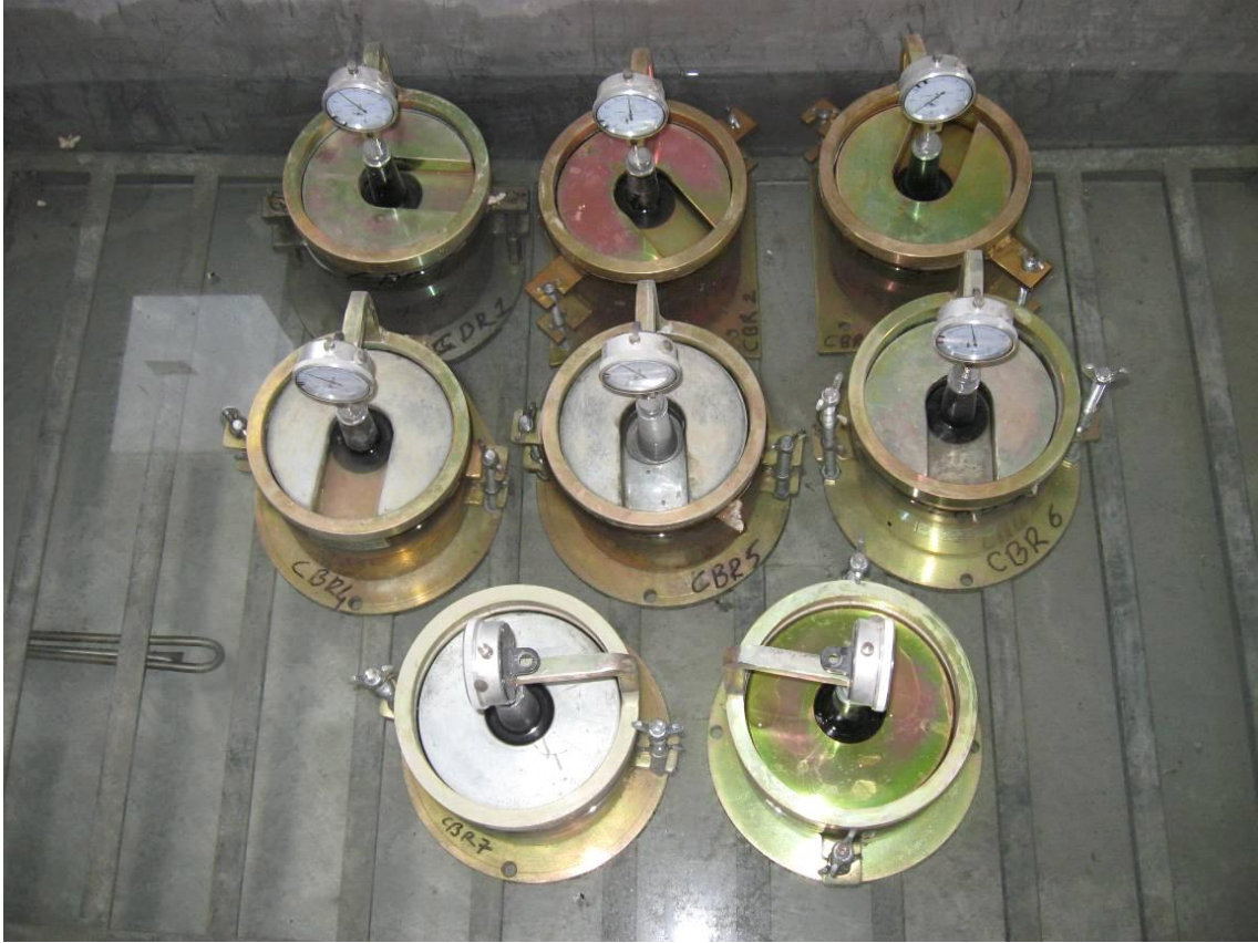
Resim 2.25 CBR testinden bir görüntü, Yapı Merkezi laboratuvarı, 2010
