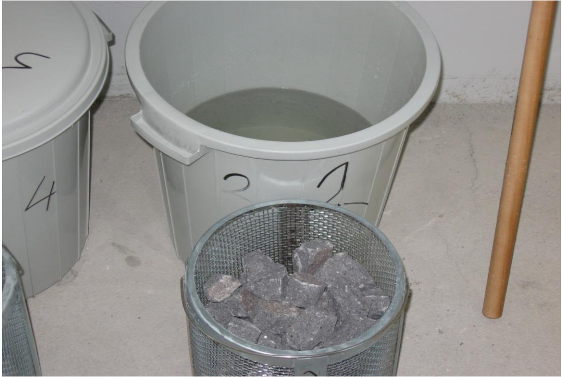
Resim 3.22 Magnezyum sülfat testi başlatılması, YM laboratuvarı, 2010
