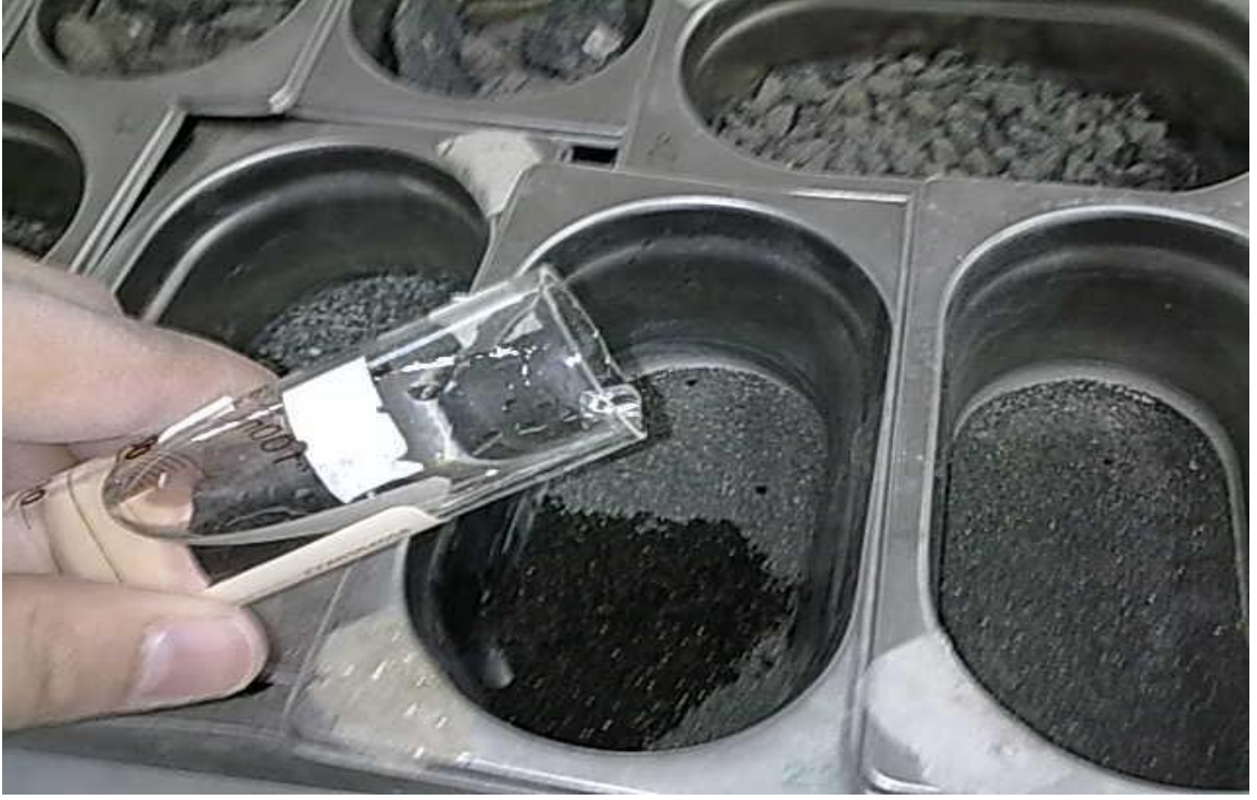
Resim 3.25 Hacituğrul ocağı sülfat don kaybı için hazırlanan numuneler ve devam eden test, YM laboratuvarı, 2010
