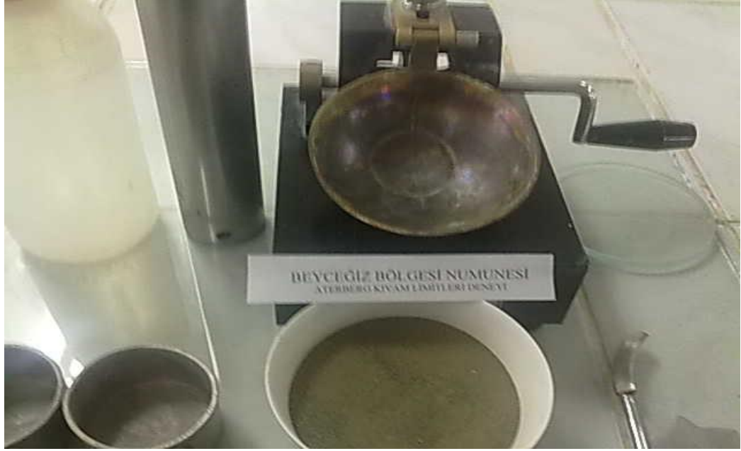
Resim 3.11 Atterberg kıvam limitleri için hazırlanan beyceğiz numunesi
