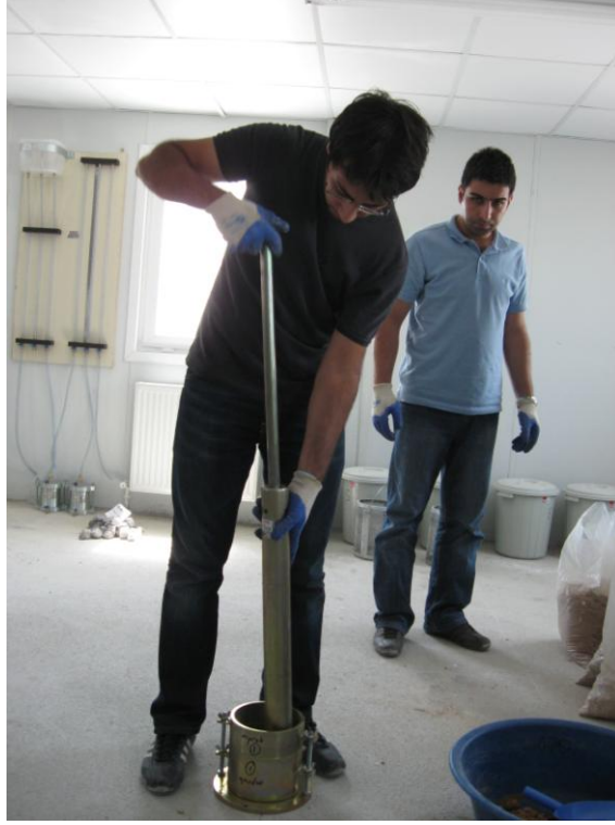
Foto 2.19 Proktor deneyinden bir görüntü, Yapı Merkezi laboratuvarı, 2009
