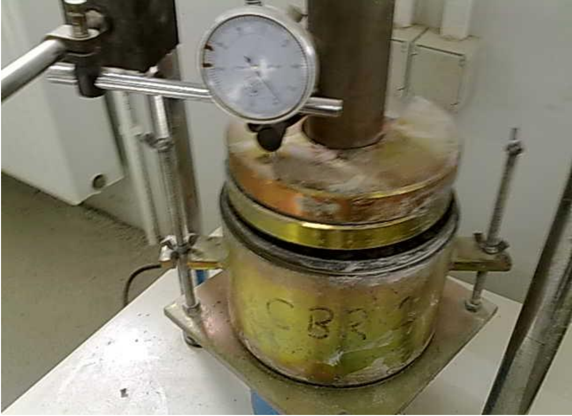
Resim 3.18 Beyceğiz numunesi üzerinde yapılan CBR testi, YM laboratuvarı 2010
