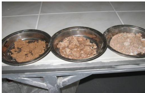
Resim 2.2 Su içeriği belirlemek için hazırlanan numuneler
