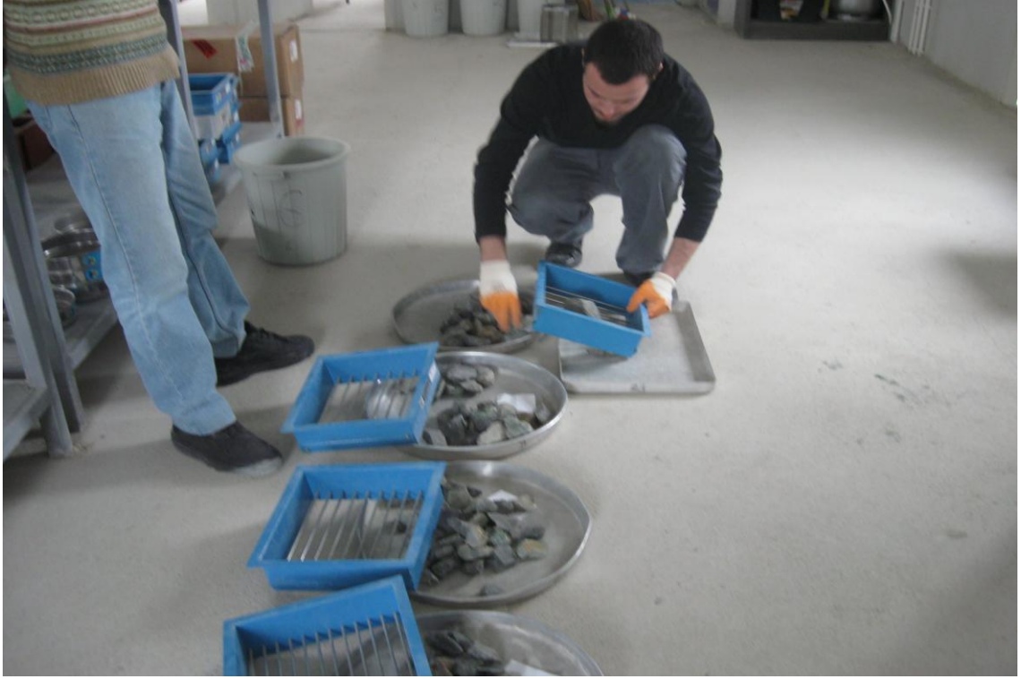
Resim 3.8 Yassılık indeksi tayini, Yapı Merkezi laboratuvarı, 2009
