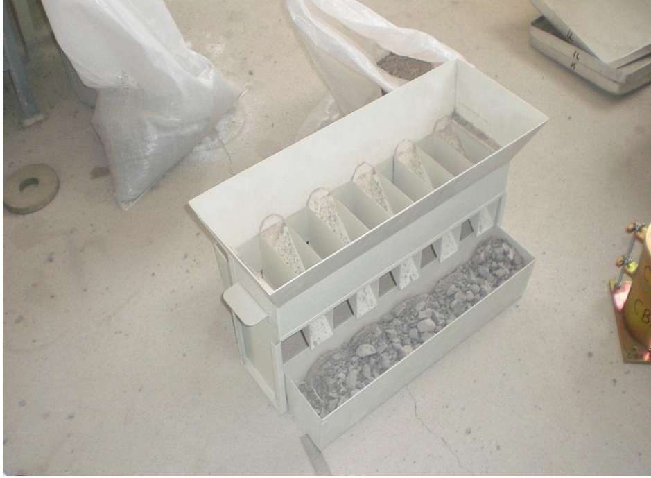
Resim 3.20 Hacituğrul numune bölgeçleme işlemi, YM laboratuvarı, 2010
