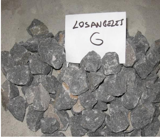
Resim 2.33, 2.34 Losangeles testi için hazırlanmış iri agrega numuneleri, 2009
