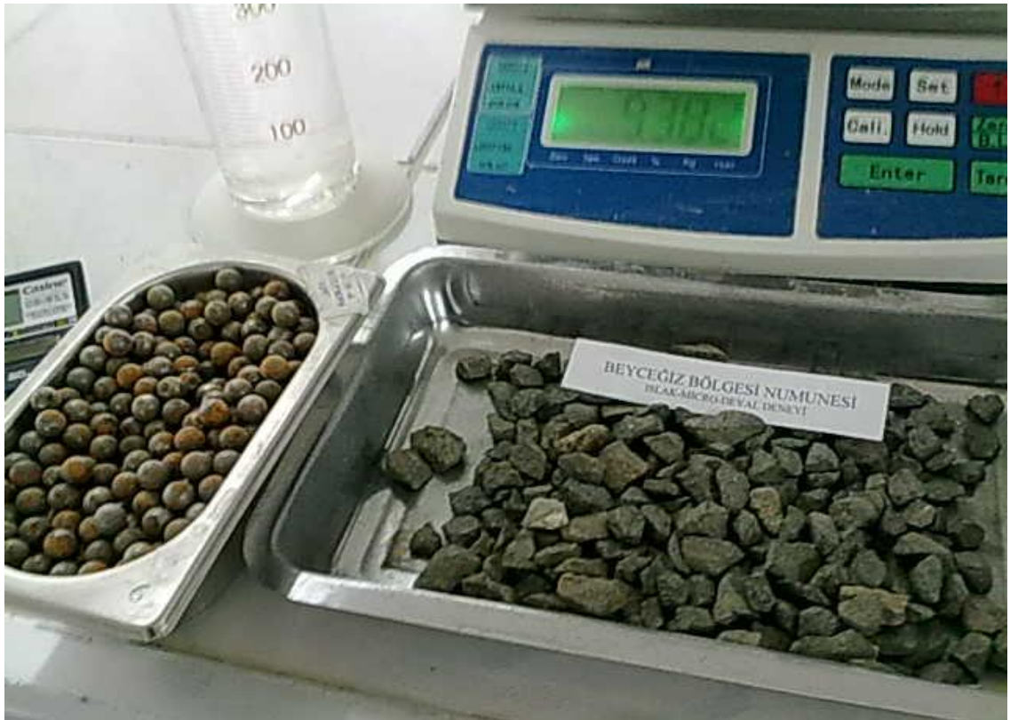
Resim 3.17 Beyceğiz numunesi micro_deval testi, YM laboratuvarı 2010
