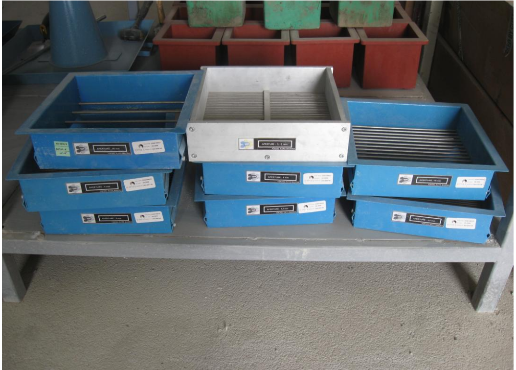
Resim 4.10 Deneylerde kullanılan kalibrasyonlu yassılık indeksi elekleri, 2010
