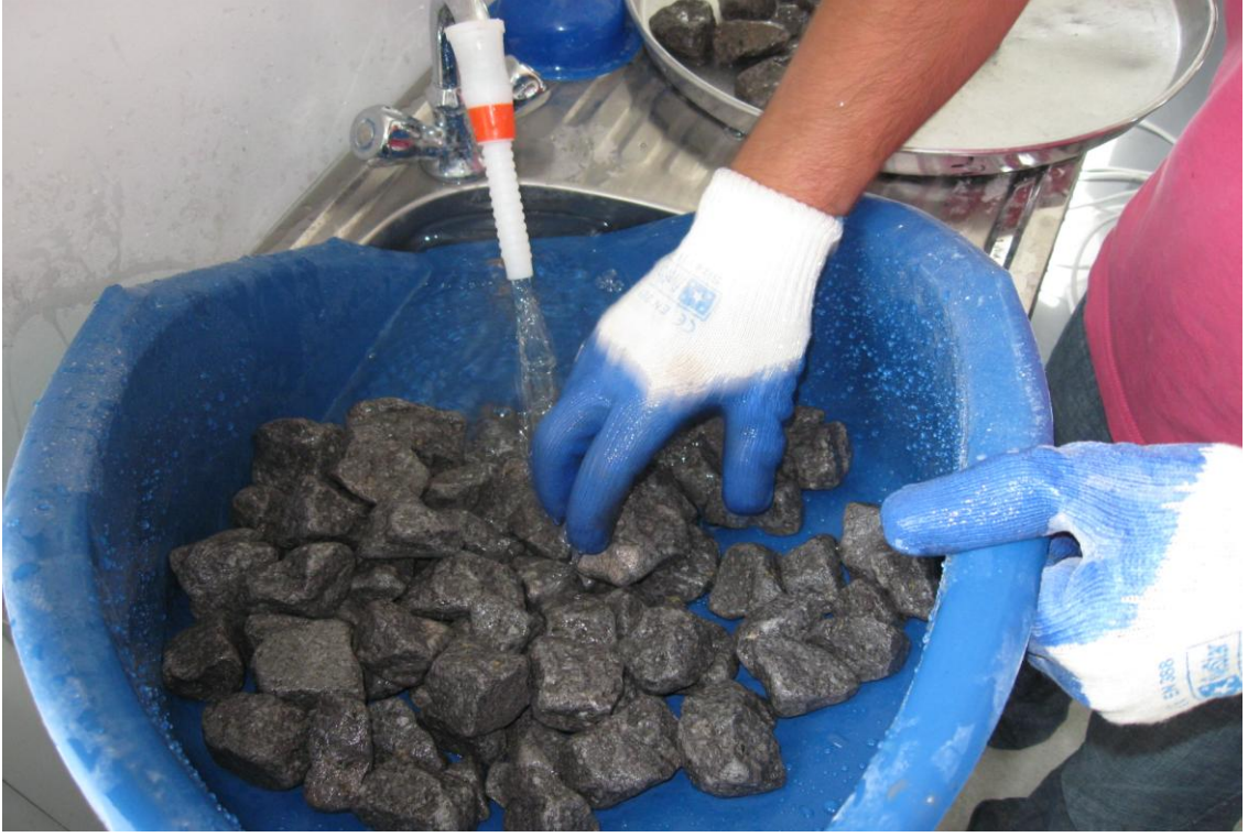
Resim 3.21 Losangeles numunesinin etüv için hazırlanması, YM laboratuvarı, 2010
