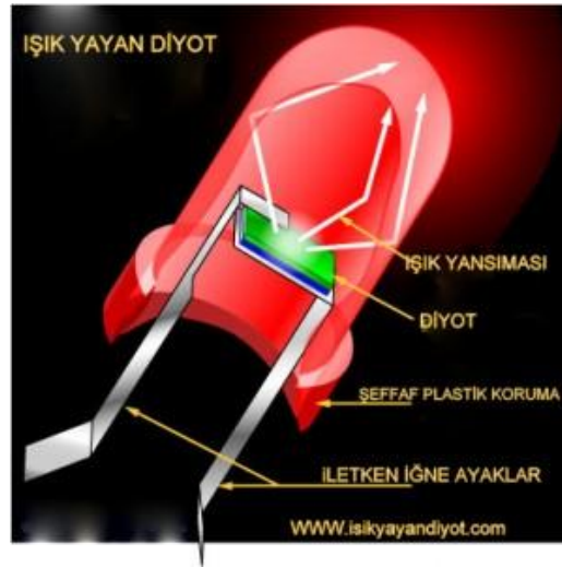
Şekil 1.22. Işık yayan diyot (LED) yapısı (anonim www.ııkyayandıyot.com )
