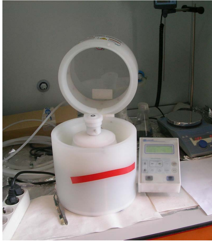
Şekil 3.1. Döndürerek kaplama yöntemi deney düzeneği
