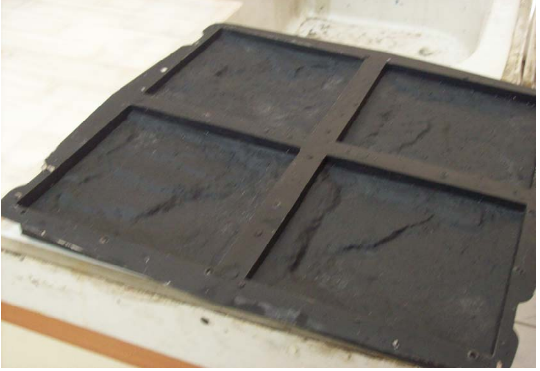
Şekil 4.41. Laboratuvar ortamında plaka örnekleri için kullanılan endüstriyel boyutta olan kalıp örneği
