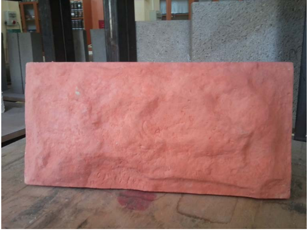
Şekil 4.34. Laboratuvar ortamında üretilen, renklendirilmiş ve endüstriyel boyuta bire bir uyan yalıtım plaka örneği
