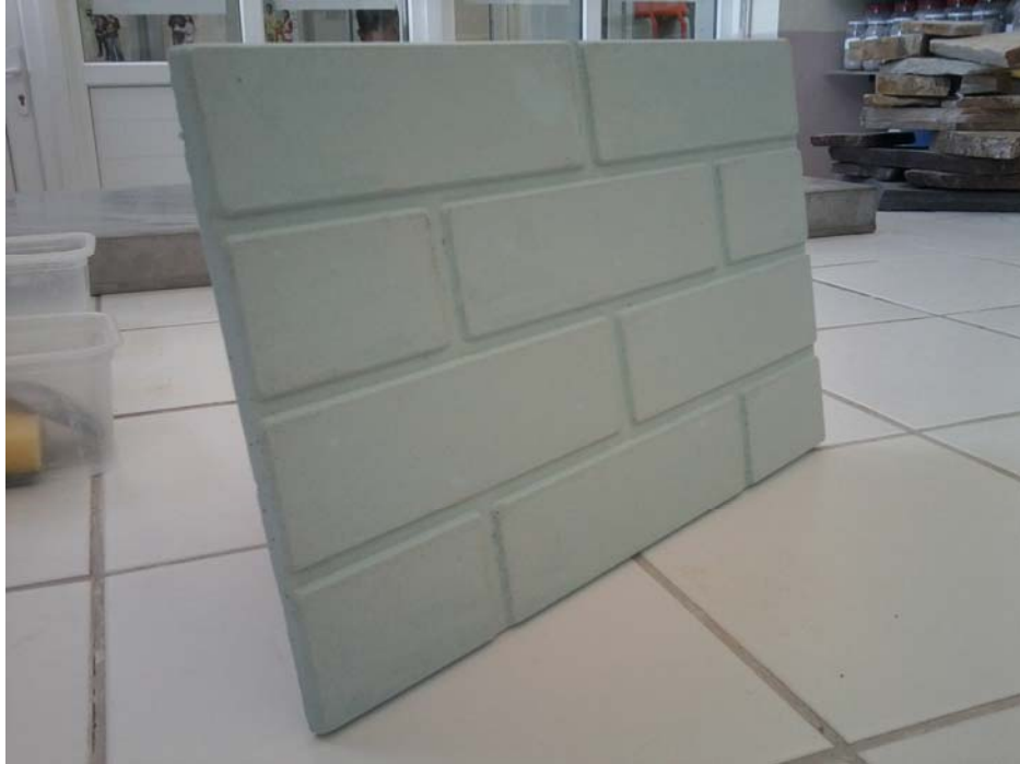
Şekil 4.33. Laboratuvar ortamında üretilen, renklendirilmiş ve endüstriyel boyuta bire bir uyan yalıtım plaka örneği
