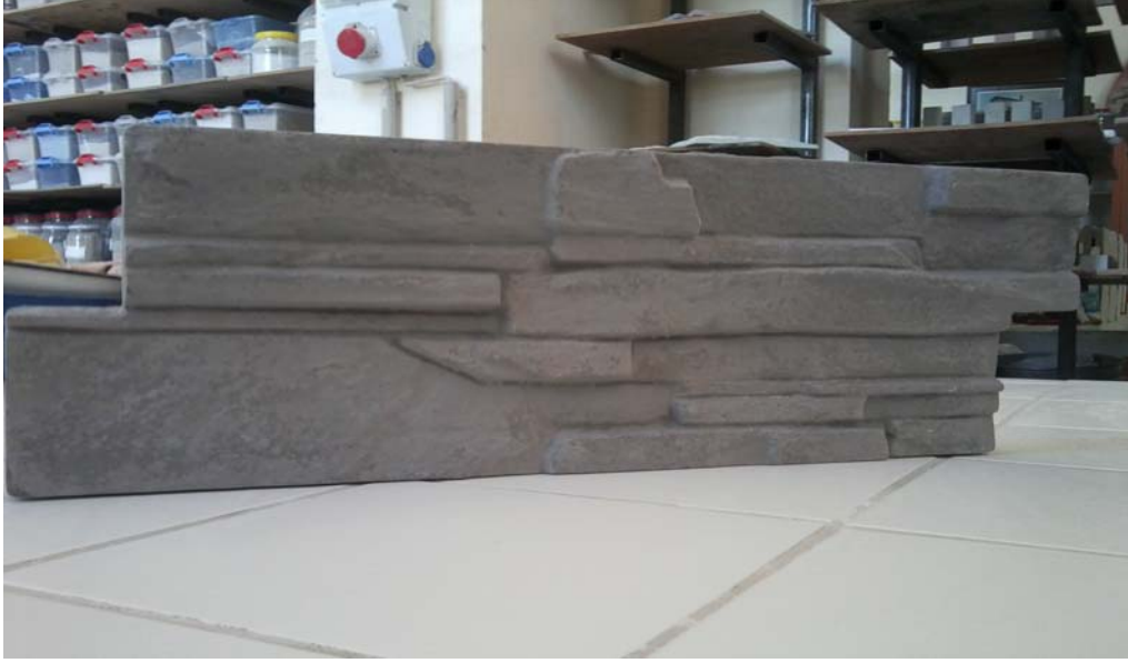
Şekil 4.32. Laboratuvar ortamında üretilen, renklendirilmiş ve endüstriyel boyuta bire bir uyan yalıtım plaka örneği
