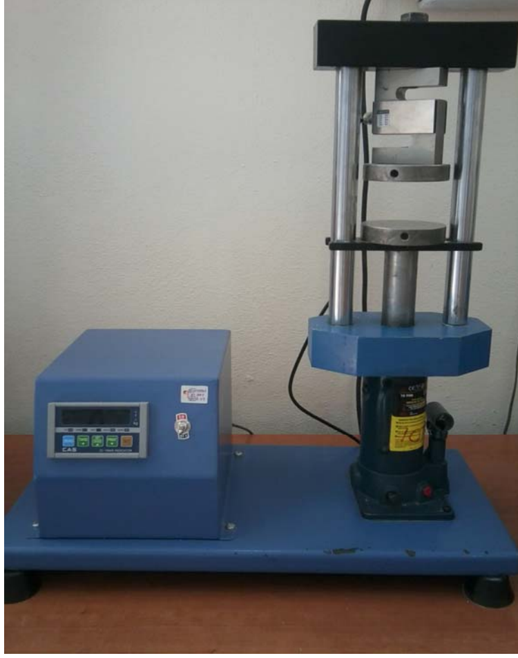
Şekil 4.1. Sertleşmiş kompozit harcın basınç dayanım analiz düzeneği
