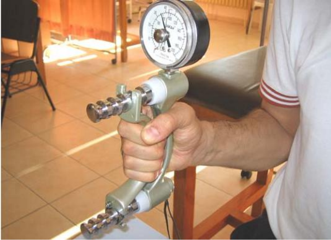
Şekil 79. Kavrama Kuvveti Ölçümü (218)
