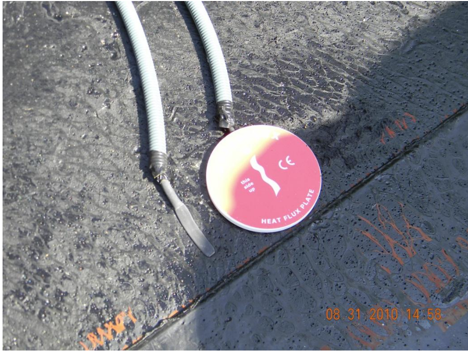
Ek-7.2.4 - Isı akısı ölçüm plakaları ve termočiftler
