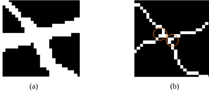
Şekil 2.3 Yanlış sınıflandırma örneği (a) Kesişim noktası (b) Thinning işleminin ardından iki çatal nokta olarak değerlendirilen damar görüntüsü.
