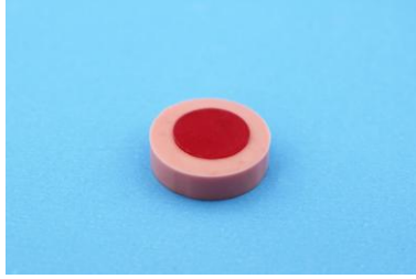
řekil 3-2: Silikon kalıba alınmış akrilik materyali ve akrilik maket
