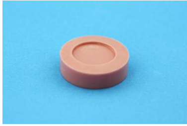
řekil 3-1: Silikon kalıp ve akrilik reçine materyali
