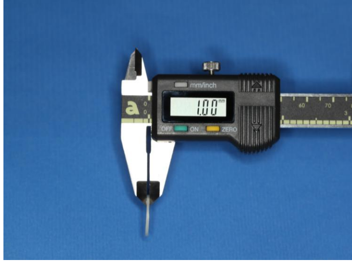
Şekil 3-12: Altyapı kalınlığının ölçülmesi
