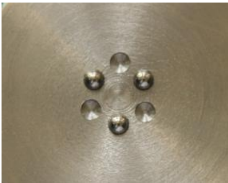
Şekil 3-16: Biaksiyel bükme testi için kullanılan alt sabit ve üst hareketli parça
