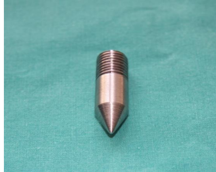
Şekil 3-16: Biaksiyel bükme testi için kullanılan alt sabit ve üst hareketli parça
