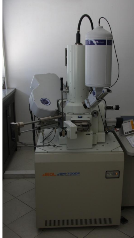
Şekil 3-19: Alan Saçılması Tarama Elektron Mikroskobu (SEM)
