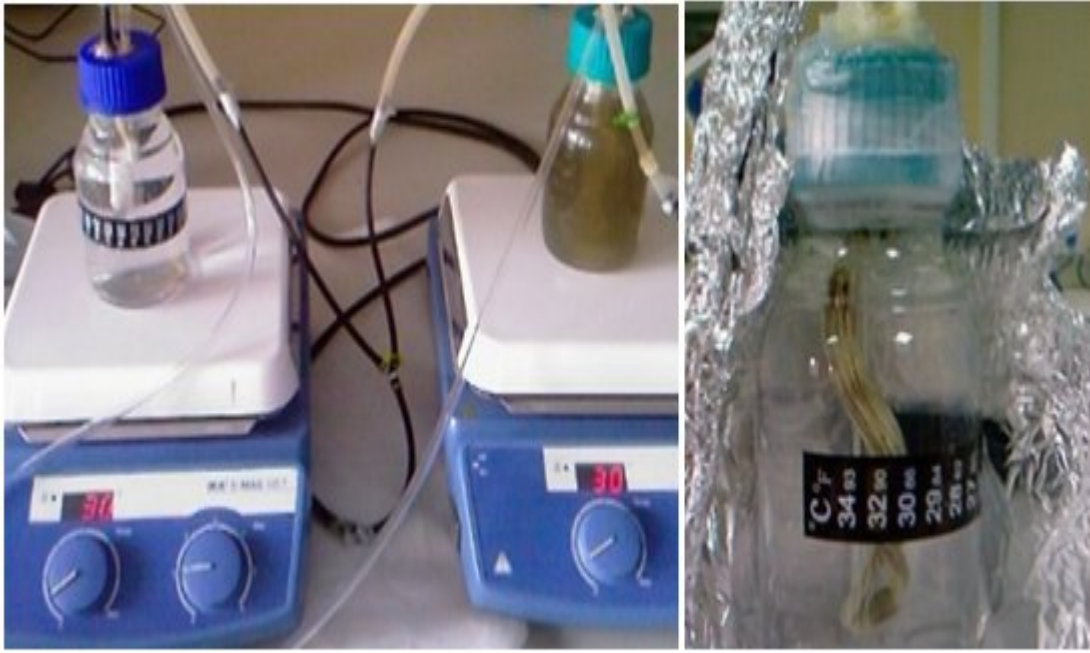
Fotoğraf 4.1. A) Aşılama Öncesi Sistemin Görünümü B) Membran Yüzeyine Mikroorganizma Tutunduktan Sonra Sistemin Görünümü
